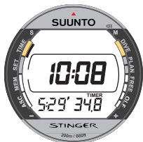
Fig. 2.7 En función cronómetro, la pantalla muestra la hora, los minutos y los segundos.
