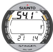
Fig. 3.21 Pantalla Nitrox. La profundidad máxima calculada en función del % O 2 (21%) y de la PO 2 (1,4 bar) es de 54,1 m.
