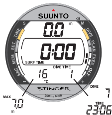
Fig. 3.32 Pantalla Superficie después de una apnea. La ventana central muestra el tiempo de intervalo en superficie.
