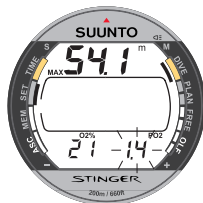
Fig. 4.9 Ajuste del porcentaje de oxígeno y de la presión parcial.
