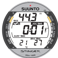
Fig. 3.26 Pantalla superficie después de no respetar un procedimiento de descompresión. La mención ASC TIME indica que la profundidad techo ha sido superada durante más de tres minutos. Usted no deberá realizar inmersiones durante, al menos, 48 horas.
