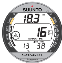
Fig.3.7 Marcaje activado. La señal se sitúa sobre un punto del perfil de la inmersión, presionando el botón S. El símbolo de atención se muestra en el momento que usted presiona el botón.
