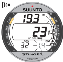
Fig. 3.23 Pantalla de la presión parcial y del indicador OLF. Suena una alarma y el último segmento del indicador parpadea cuando el valor OLF alcanza el 80%. Cuando el valor OLF alcanza el 100% todos los segmentos parpadean. Si el valor OTU es superior al del CNS, parpadea el primer segmento.
