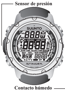
Fig. 2.2 Contacto húmedo y sensor de presión.
