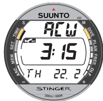
Fig. 2.3 La abreviación ACW indica que el contacto está activado.
