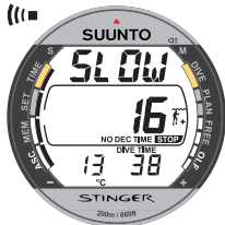
Fig. 3.15 Indicador de la velocidad de ascenso. Mención SLOW parpadeando y aparecen 4 segmentos: la velocidad de ascenso es superior a 10m/min. Es necesario disminuir la velocidad de ascenso. La señal STOP significa que deberá efectuar una parada de seguridad obligatoria cuando la profundidad sea de 6 m.
