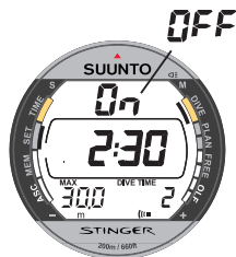
Fig. 4.13 Alarma de Tiempo de Inmersión. Aparece cuando el tiempo de inmersión es inferior a 5 minutos. El tiempo se muestra en la ventana central.
