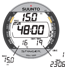
Fig. 3.35 Pantalla alternativa después de una utilización en modo Medición. La ventana central muestra el Tiempo Sin Volar.
