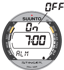
Fig. 4.6 Modo Ajuste de la alarma despertador activada.
