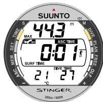
Abb. 3.26. Oberflächenmodus nach Nichtbeachten einer Dekompressionsstufe. Das ASC TIME-Symbol zeigt, dass Sie eine Dekompressionsstufe länger als 3 Minuten nicht beachtet haben. Die alternierende Anzeige gibt an, dass Sie innerhalb der nächsten 48 Stunden nicht nochmals tauchen dürfen.
