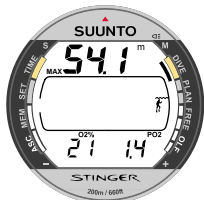
Abb. 3.21. Nitrox-Anzeige. Die maximale Tiefe basierend auf den Einstellungen O 2 % (21%) und PO 2 (1,4 bar) beträgt 54,1 m [177ft].
