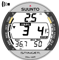
Abb. 3.14. Verletzung des verbindlichen Sicherheitsstops. Der abwärts gerichtete Pfeil und der akustische Alarm weisen Sie darauf hin, auf die geforderte Tiefe abzutauchen.
