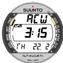
Abb. 2.3. Die Aktivierung des Wasserkontakts wird durch den Text "ACW" dargestellt.
