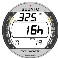
Abb. 5.9. Tauchgangshistorie zu Gerätetauchgängen: Zahl der Tauchgänge, Tauchzeit und maximale Tiefe.
