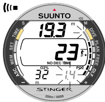
Abb. 3.23. Sauerstoffpartialdruck und OLF-Anzeige. Es ertönt akustischer Alarm und das letzte Segment der Balkenanzeige beginnt zu blinken, weil der Sauerstoffgrenzbereich OLF 80% erreicht hat. Erreicht der OLF-Wert 100%, beginnen alle Segmente zu blinken. Übersteigt der OTU-Wert den ZNS-Wert, blinkt das unterste Segment.
