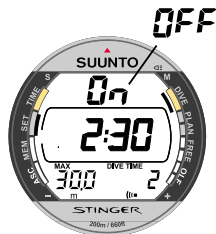
Abb. 4.13. Tauchzeitalarm. Das mittlere Display zeigt eine verbleibende Tauchzeit unter 5 Minuten an.
