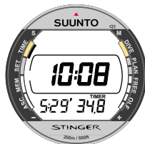
Abb. 2.7. Die Stopuhr zeigt Stunden, Minuten und Sekunden.
