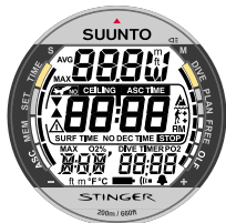
Abb. 3.2. Startdisplay I. Alle Segmente der Anzeige erscheinen.
