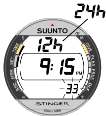
Abb. 4.3. Der Modus zur Zeiteinstellung ist aktiv und die zweiten Ziffern blinken. Seite I.
