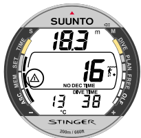
Abb. 3.7. Hinterlegen eines Lesezeichens. Ein Lesezeichen wird im Profilspeicher während des Tauchgangs eingetragen, indem der Knopf S gedrückt wird. Er wird durch das Achtung-Symbol angezeigt.
