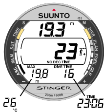
Abb. 3.11. Anzeige während des Tauchgangs. Die aktuelle Tiefe ist 19,3 m [63 ft] und die Nullzeit beträgt im Modus A0/ P1 23 Minuten. Die maximal bei diesem Tauchgang erreichte Tiefe war 19,8m [65 ft], bisherige Tauchzeit ist 16 Minuten. Die alternative Anzeige zeigt Temperatur und aktuelle Uhrzeit.
