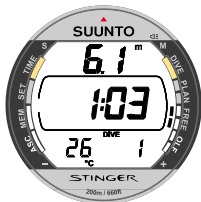
Abb. 3.29. Freitauchgang. Die aktuelle Tiefe beträgt 6,1m, die Tauchzeit 1.03 Minuten, die Tauchgangsnummer ist 1.
