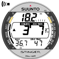
Abb. 3.17. Dekompressionstauchgang unterhalb der Dekompressionsgrenze. Der aufwärts gerichtete Pfeil, die blinkende Anzeige ASC TIME und ein akustischer Alarm weisen Sie darauf hin, aufzusteigen. Die minimale Aufstiegszeit beinhaltet den Sicherheitsstopp und beträgt 7 Minuten. Die Deko-Stufe liegt bei 3m [10ft].
