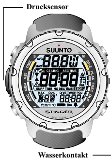
Abb. 2.2. Wasserkontakt und Drucksensor.
