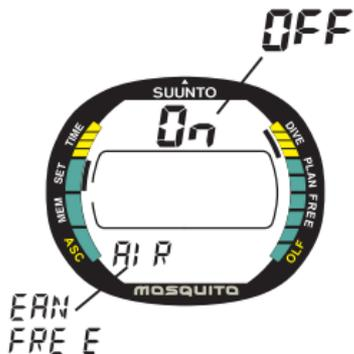
Fig. 4.8 Ajuste del Modo AIR/EAN/FREE. Activación/Desactivación parpadeando.
