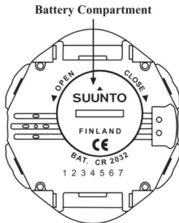
Fig. 6.1 Tapa del compartimento de la pila.
