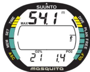
Fig. 3.21 Pantalla Nitrox. La profundidad máxima calculada en función del % O<sub>2</sub> (21%) y de la PO<sub>2</sub> (1,4 bar) es de 54,1 m.
