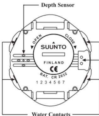
Fig. 2.2 Contacto húmedo y sensor de presión.
