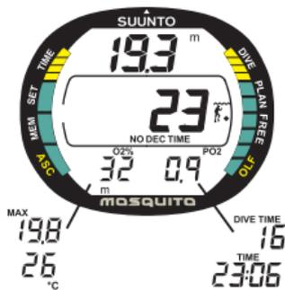
Fig. 3.22 Inmersión en Modo EAN. El % de O<sub>2</sub> está ajustado al 32%. La PO<sub>2</sub> es de 0,9. Las pantallas alternas son la profundidad máxima, la temperatura, el tiempo de inmersión y la hora.
