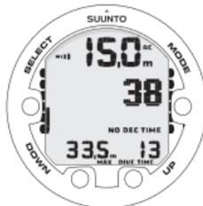
DISPLAY IMMERSIONE – PROFONDITÀ ATTUALE: 15 METRI, PROFONDITÀ MAX. DI IMMERSIONE: 33,5 METRI, TEMPO LIMITE DI STOP DI NON DECOMPRESSIONE: 38 MINUTI, TEMPO DI IMMERSIONE TRASCORSO: 13 MINUTI.
