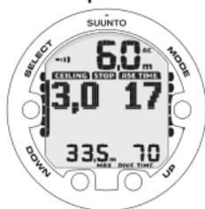
QUANDO LA FRECCIA VERSO L'ALTO SCOMPARE E L'INDICAZIONE DEL TEMPO DI RISALITA SMETTE DI LAMPEGGIARE SIGNIFICA CHE SI È NELL'INTERVALLO DI DECOMPRESSIONE.
