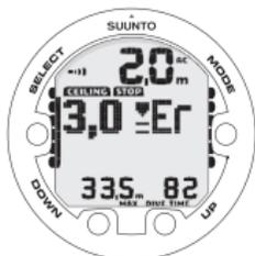
IMMERSIONE CON DECOMPRESSIONE, AL DI SOPRA DEL MASSIMALE. PRESTARE ATTENZIONE ALLA FRECCIA VERSO IL BASSO, ALL'AVVISO DI ERRORE E ALL'ALLARME. È NECESSARIO SCENDERE IMMEDIATAMENTE (ENTRO 3 MINUTI) AL LIVELLO DEL MASSIMALE O A UNA PROFONDITÀ MAGGIORE.
