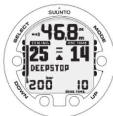
DURANTE LA DISCESA VIENE VISUALIZZATA LA NECESSITÀ DI EFFETTUARE UNA SOSTA DI PROFONDITÀ A 25 METRI.
