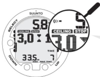
QUANDO IL DISPLAY INDICA STOP E CEILING, EFFETTUARE UNA SOSTA DI SICUREZZA OBBLIGATORIA DI UN MINUTO NEL CAMPO DI PROFONDITÀ COMPRESO TRA 6 E 3 METRI.
