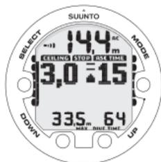
LA FRECCIA VERSO L'ALTO, IL TEMPO DI RISALITA CHE LAMPEGGIA E UN ALLARME INDICANO CHE È NECESSARIO RISALIRE. IL TEMPO DI RISALITA TOTALE MINIMO, CON SOSTA DI SICUREZZA OBBLIGATORIA, È DI 15 MINUTI. IL LIVELLO DEL MASSIMALE È 3 METRI.
