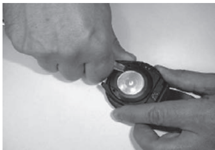
Fig. 5.2 Het losdraaien van de bevestigingsring.
