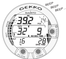
Fig. 3.23 PO 2 en OLF displays. Er klinkt een waarschuwing wanneer de PO 2 groter is dan 1.4 bar (of een andere waarde als deze veranderd is) en wanneer de OLF 80% bereikt.
