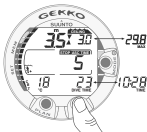
Fig. 3.17 Decompressieduik, binnen de decompressiezone. De twee naar elkaar wijzende driehoekjes vormen een zandloperkje. U bevindt zich binnen de optimale decompressiezone op 3.5 m diepte en uw resterende opstijgtijd is minimaal 5 min. Door op de TIME knop te drukken kunt u het alternatieve display oproepen.
