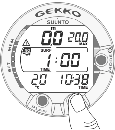
Fig. 3.27 Oppervlakte-interval, weergave van oppervlakte-interval. Door op de TIME knop te drukken kunt u de huidige oppervlakte-interval oproepen.
