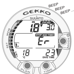
Fig. 3.18 Decompressieduik, boven het decompressieplafond. Let op de naar beneden wijzende driehoek en de Er-waarschuwing en het alarmsignaal. U moet nu (binnen 3 minuten) afdalen tot beneden het decompressie-plafond.
