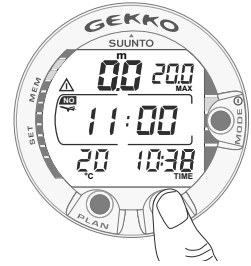
Fig. 3.28 Oppervlakte-interval, tijd van vliegverbod. Door twee keer op de TIME knop te drukken kunt u de resterende tijd van het vliegverbod oproepen.
