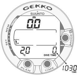
Fig. 3.3 Startup III. De Surface Mode of oppervlaktestand: De diepte en duiktijd zijn 0. Door op de TIME knop te drukken activeert u de alternatieve displays met de temperatuur en de huidige tijd.
