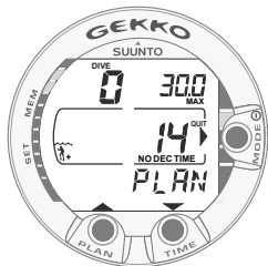
Fig. 3.5 Duikplanning. De duikplanner wordt aangeduid met de tekst PLAN. De geen-decompressielimiet (multijd) voor een duik op 30.0 m is 14 minuten, in stand A0/P1.
