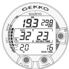
Fig. 3.25 Het onderste segment van de OLF grafiek knippert om aan te duiden dat OTU's worden getoond, en niet het CNS O 2 %.
