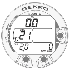
Fig. 3.21 Opperflaktedisplay in de Nitroxmodus
