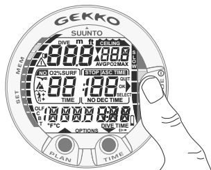
Fig. 3.1 Startup I. Alle segmenten zijn zichtbaar.
