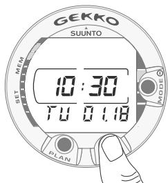
Fig. 2.1 Het tijdsdisplay. Het indrukken van de PLAN of TIME knop activeert het display.
