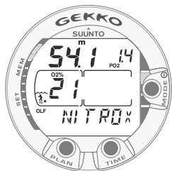
Fig. 3.20 Nitrox display. De maximum diepte, gebaseerd op 21% O 2 en een PO 2 van 1.4 bar is 54.1 meter.
