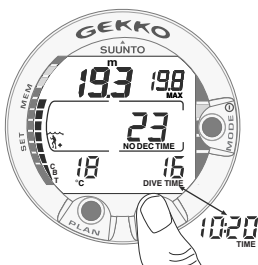
Fig. 3.7 Duikdisplay. De huidige diepte is 19.3 m [63 ft] en de resterende geen-decompressietijd is 23 minuten in stand A0/P1. De maximumdiepte voor deze duik was 19.8 m [65 ft], de verstreken duiktijd is 16 minuten en de watertemperatuur is 18° C [64° F]. De huidige tijd zal 5 seconden lang getoond worden wanneer u de TIME knop indrukt.
