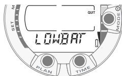
Fig. 3.2 Startup II. De batterijspanningsmeter.
