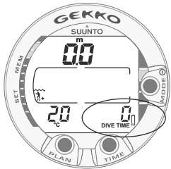
Fig. 3.4 Waarschuwing voor te lage batterijspanning. Het batterijsymbool geeft aan dat de batterijspanning te laag is en de batterij vervangen moet worden.
