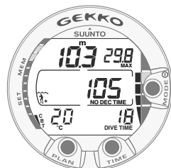
Fig. 3.11. Stijgsnelheidsmeter. Maximale stijgsnelheid: vier segmenten zichtbaar.
