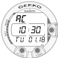
Fig. 2.4 Actieve watercontacten worden aangeduid met de tekst AC.
