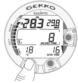
Fig. 3.8. Een aandachtspunt of annotatie wordt in het profiel geheugen geplaatst door op de PLAN knop te drukken. Let op het logboek-symbooltje.
