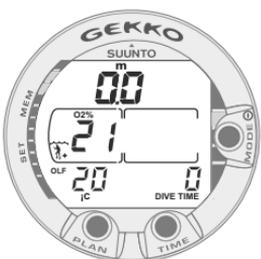
Fig. 3.21. Il display di superficie in programma Nitrox
