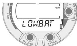
Fig. 3.2. Attivazione II. Indicatore di carica della batteria
