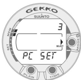
Fig. 4.14. Trasferimento Dati ed Interfaccia PC [3 PC SET].
