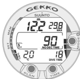
Fig. 3.10. Indicatore di Velocità di Risalita. Tre segmenti.
