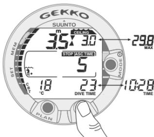
Fig. 3.17. Immersione con decompressione, profondità di Ceiling. Icona a clessidra, le due frecce con le punte rivolte l'una verso l'altra. Si è a profondità di 3,5 m [11 ft], nella zona ottimale di Ceiling, il tempo totale di risalita minimo è 5 minuti. Premendo il pulsante TIME si attiva il display alternativo.
