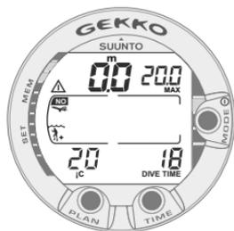
Fig. 3.26. Display Superficie. È stata effettuata una immersione di 18 minuti durante la quale si è raggiunta la profondità massima di 20,0 metri [66 ft]. La profondità attuale è 0,0 metri [0 ft]. Il simbolo dell'Aereo indica di evitare spostamenti utilizzando aere o ad altitudini significativamente più elevate che non quella a cui si è fatta immersione. Il simbolo Attenzione indica che è opportuno prolungare l'intervallo di superficie a causa di un eccesso di formazione di Microbolle.
