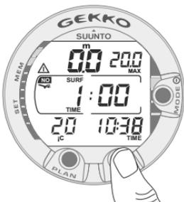
Fig. 3.27. Intervallo di superficie, display Superficie. Premendo il pulsante TIME una volta il computer mostra il display superficie.
