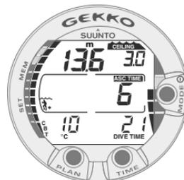
Fig. 3.16. Immersione con decompressione, al di sopra di Floor. La freccia rivolta verso l'alto è scomparsa e la scritta ASC TIME ha smesso di lampeggiare, ciò indica che si è in Range di Decompressione.
