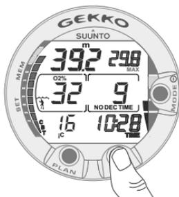
Fig. 3.24. Display alternativo. Premendo il pulsante TIME appaiono: l'ora, la profondità massima, la temperatura, il CBT e l'O<sub>2</sub>%
