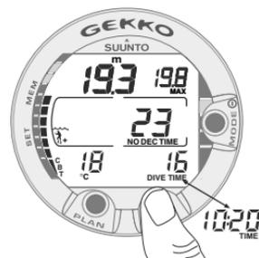
Fig. 3.7. Display in immersione. La profondità attuale è m. 19,3 [63 ft], il tempo di non decompressione, con personalizzazioni A0/P1, è 23 minuti. La massima profondità raggiunta è stata m. 19,8 [65 ft], la temperatura dell'acqua è 18° C [64° F], il tempo trascorso in immersione è 16 minuti. Il display alternativo indica l'ora, le 10:20 [10:20 am], si attiva, per 5 secondi, premendo il pulsante TIME
