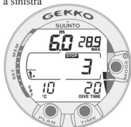
Fig. 3.9 Sosta Raccomandata di fine immersione di 3 minuti
