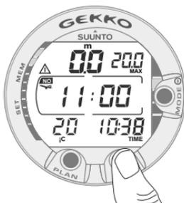
Fig. 3.28. Intervallo di superficie, tempo di non volo. Il dato, indicato con il simbolo dell'aereo, si evidenzia premendo due volte il pulsante TIME.
