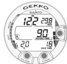
Fig. 3.10. Indicador de la velocidad de ascenso. Tres segmentos
