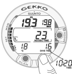
Fig. 3.7. Visualización durante la inmersión. La profundidad actual es de 19,3 m; el tiempo de inmersión sin descompresión es de 23 minutos en modo A0 / P1. La profundidad máxima alcanzada durante la inmersión es de 19,8 m; la temperatura del agua es de 18° C, y el tiempo de inmersión es de 16 minutos. Pulsando el botón TIME, se visualiza la hora durante 5 segundos.
