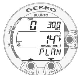
Fig. 3.5 Modo Planificación de Inmersiones. La planificación se señala mediante la indicación PLAN. El tiempo de inmersión sin descompresión a 30,0 m es de 14 minutos en modo A0 / P1.
