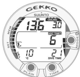
Fig. 3.16. Inmersión con paradas de descompresión, por encima de la profundidad base. La flecha ha desaparecido y la indicación ASC TIME ya no parpadea. Ud. se encuentra en la zona de descompresión.
