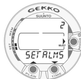
Fig. 4.18. Modo Ajuste de Alarmas.
