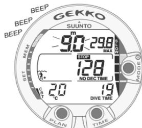
Fig. 3.12. Indicador de la velocidad de ascenso. La profundidad actual parpadea y se visualiza la indicación SLOW y 4 segmentos : la velocidad de ascenso es superior a 10 m/min. (33 pies/min). La señal STOP significa que debe realizar una parada de seguridad obligatoria cuando alcance una profundidad de 6 m (20 pies).
