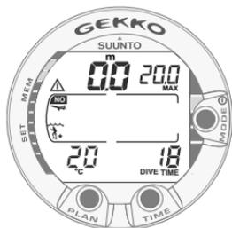
Fig. 3.26. Pantalla superficial. El buceador ha vuelto a la superficie después de una inmersión de 18 minutos, a una profundidad máxima de 20,0 m (66 pies). La profundidad actual es de 0,0 m (0 pies). El símbolo del avión indica la prohibición de realizar un desplazamiento aéreo, y el símbolo de Atención indica que debe prolongar el intervalo en superficie debido al nivel de las micro-burbujas.
