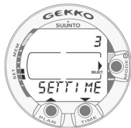
Fig. 4.21. Ajustes de los parámetros del reloj.
