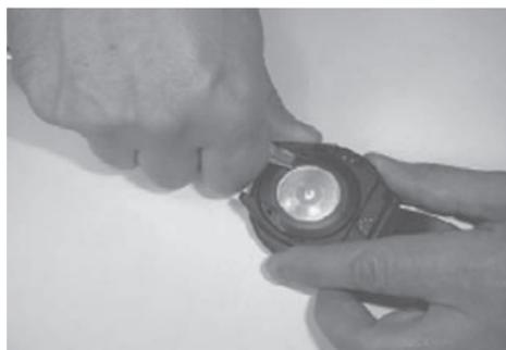
Fig. 5.2. Apertura del anillo de bloqueo.
