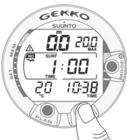
Fig. 3.27. Pantalla superficial, hora. Pulsando una vez el botón TIME, se visualiza el Modo Superficie.
