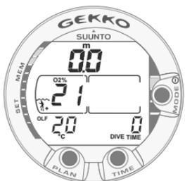
Fig. 3.21. Pantalla superficie en Modo Nitrox.
