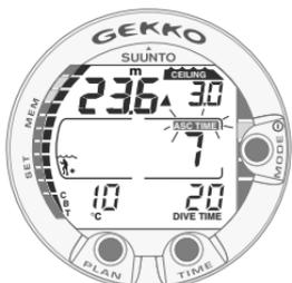
Fig. 3.15. Inmersión con paradas de descompresión, por debajo de la profundidad base. La flecha dirigida hacia arriba, el indicador intermitente ASC TIME, y la alarma acústica le recomiendan ascender. El tiempo total de ascenso mínimo, incluida la parada de seguridad, es de 7 min. La profundidad tope es de 3 m. (10 pies).
