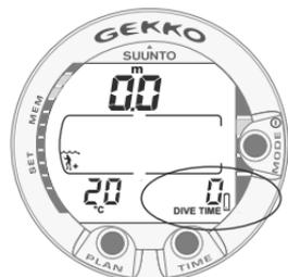
Fig. 3.4. Alarma de cambio de pila. El símbolo de pila indica que la carga de la pila está baja, y se recomienda sustituirla.
