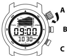
画面に印刷された線と気圧グラフを見比べます。気圧が 3 時間（最新の 4 つの測定値）で 4hpa/0.12inHg 以上低下している場合、高い確率で天候が悪くなります。気圧が上昇している場合は、天候がよいことを示しています。
