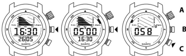
TIME (時間) モードでは、普通の時計として機能します。SAILING (セーリング) モードには、セーリング用およびレース用タイマー機能があります。
