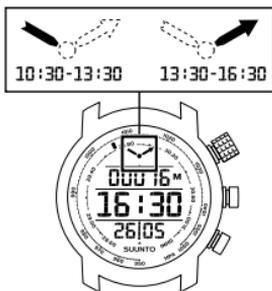
Стрелки тенденции барометрического давления обновляются каждые 30 минут, однако отображаются только значительные изменения (2 гПа и более за 3 часа). Измерение атмосферного давления и его преобразование к значению атмосферного давления на уровне моря производится каждую минуту, и каждый раз значение обновляется на индикаторе внешнего периферийного сегмента.
