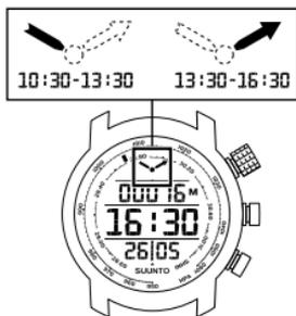
気圧傾向の矢印は 30 分毎に更新されますが、大きな変化（3 時間に 2 hPa 以上）のみが示されます。気圧の測定と海面気圧への変換は毎分行われ、値は毎回外枠に更新されます。
