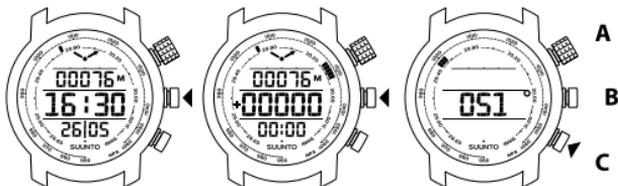
TIME (時間) モードでは、普通の時計として機能します。ALTITUDE RECORDING (高度) モードでは、高度の測定と記録の機能が追加されます。COMPASS (コンパス) ビューアは、磁北を基準にして自分の向きをあわせるのに役立ちます。
