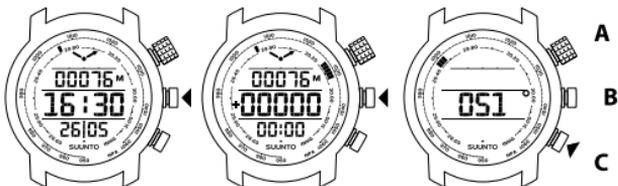
Nella modalità **TIME** (ora), il dispositivo funziona con un normale orologio. La modalità **ALTITUDE RECORDING** (registrazione altitudine) include tutte le funzioni relative alla misurazione e alla registrazione dell'altitudine.
