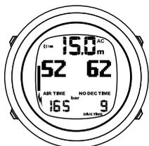
Il cambiamento di consumo d'aria da parte del subacqueo si basa su misurazioni di pressione costanti a intervalli di un secondo, considerate nell'arco di periodi di 30–60 secondi. Un aumento del consumo d'aria riduce rapidamente il tempo d'aria rimanente, mentre un abbassamento del consumo d'aria incrementa lentamente il tempo d'aria. Questo sistema di calcolo permette di evitare una stima del tempo d'aria troppo ottimistica che si otterrebbe da un abbassamento temporaneo del consumo d'aria.
