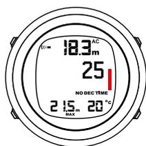
Se si supera la velocità di risalita massima consentita, il segmento inferiore della barra inizia a lampeggiare, mentre il segmento superiore resta fisso.
