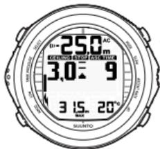
LA FRECCIA VERSO L'ALTO, IL TEMPO DI RISALITA CHE LAMPEGGIA E UN ALLARME INDICANO CHE È NECESSARIO RISALIRE. IL TEMPO DI RISALITA TOTALE MINIMO, CON SOSTA DI SICUREZZA, È DI 9 MINUTI. IL LIVELLO DEL MASSIMALE È 3 METRI.
