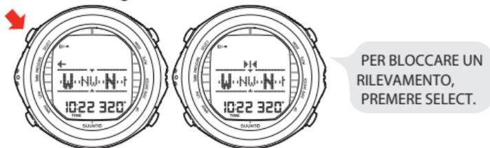
Suunto D9tx permette inoltre di seguire rotte a triangolo o a quadrato e facilita la localizzazione della rotta del ritorno. Per far ciò, basta seguire i simboli grafici visualizzati al centro del display della bussola:
