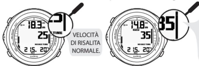
L'ATTIVAZIONE DELLA RETROILLUMINAZIONE E DELL'ALLARME E IL LAMPEGGIO DELLA BARRA DELLA VELOCITÀ DI RISALITA INDICANO CHE LA RISALITA AVVIENE AD UNA VELOCITÀ SUPERIORE A 10 M/MIN E CHE È NECESSARIO EFFETTUARE UNA SOSTA DI SICUREZZA OBBLIGATORIA QUANDO SI ARRIVA ALLA PROFONDITÀ DI 6 M.
