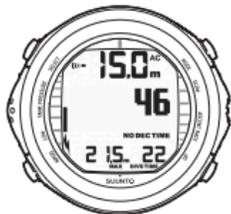
DISPLAY IN IMMERSIONE – LA PROFONDITÀ ATTUALE È DI 15 M, IL LIMITE DEL TEMPO DI STOP DI NON DECOMPRESSIONE È 46 MINUTI. LA MASSIMA PROFONDITÀ RAGGIUNTA È STATA DI 21,5 M, IL TEMPO TRASCORSO IN IMMERSIONE È 22 MINUTI.
