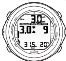
DUE FRECCHE RIVOLTE UNA VERSO L'ALTRA: "CLESSIDRA": SI RAGGIUNGE LA ZONA OTTIMALE DI CEILING A 3 METRI E IL TEMPO DI RISALITA MINIMO È DI 9 MINUTI.
