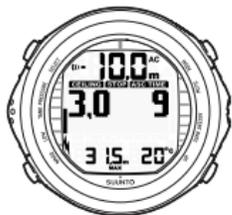
LA SCOMPARSA DELLA FRECCIA VERSO L'ALTO E L'ARRESTO DEL LAMPEGGIO DEL TEMPO DI RISALITA INDICANO CHE SI È NEL CAMPO DI DECOMPRESSIONE.
