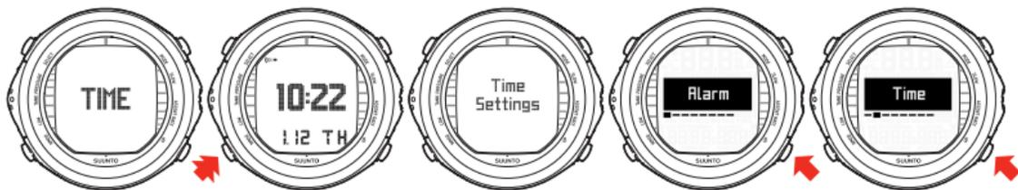
UTILICE LOS BOTONES UP Y DOWN PARA CAMBIAR ENTRE LOS MODOS ALARM, TIME, DUAL TIME, DATE, UNITS, CONTRAST Y TONES.
