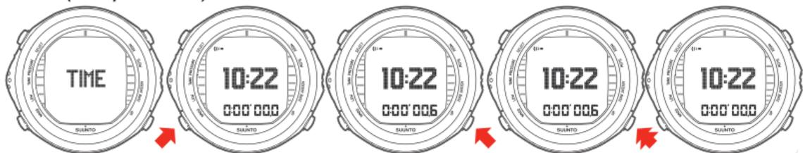
UTILICE EL BOTÓN DOWN PARA PONER EN MARCHA EL CRONÓMETRO Y TOMAR TIEMPOS INTERMEDIOS. EL BOTÓN UP DETIENE EL CRONÓMETRO. SI HA TOMADO TIEMPOS INTERMEDIOS, PUEDE DESPLAZARSE PULSANDO BREVEMENTE EL BOTÓN UP. SI MANTIENE PRESIONADO EL BOTÓN UP SE PONE A CERO EL CRONÓMETRO.
