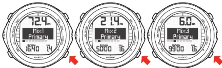
En el modo de ajuste de MIXED (MEZCLA) se muestra también la profundidad máxima operativa en función del ajuste seleccionado.
