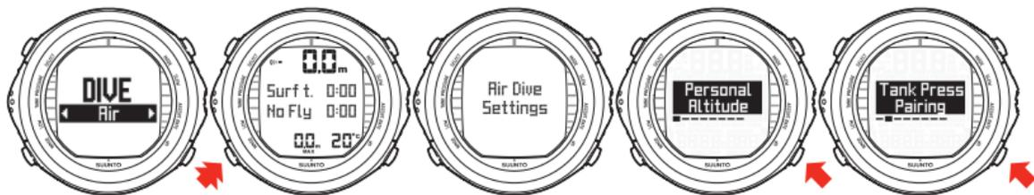
UTILICE LOS BOTONES UP Y DOWN PARA CAMBIAR DE UN AJUSTE DE BUCEO A OTRO.
