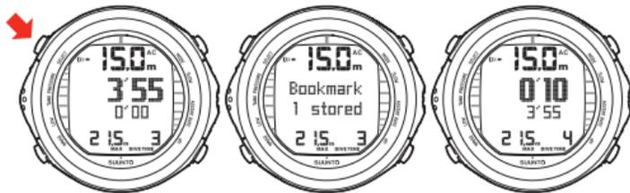
AL PRESIONAR EL BOTÓN SELECT DURANTE UNA INMERSIÓN, SE GUARDA UN MARCADOR EN LA MEMORIA DEL PERFIL, EL TEMPORIZADOR DE INMERSIÓN SE PONE A CERO Y EL INTERVALO CRONOMETRADO ANTERIORMENTE SE MUESTRA EN LA PARTE INFERIOR.
