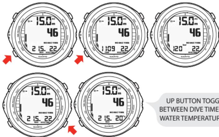
DOWN BUTTON TOGGLES BETWEEN MAXIMUM DEPTH, CURRENT TIME AND TANK PRESSURE.
