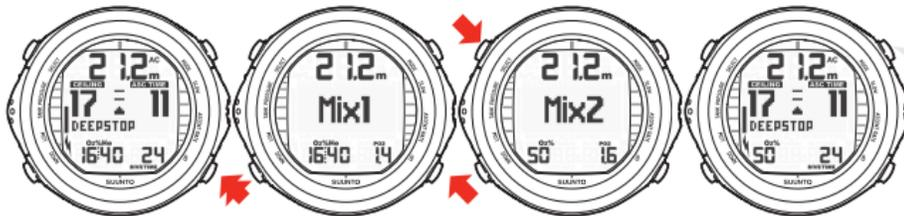
CHANGING GAS MIX. LONG PRESS UP, THEN SCROLL THROUGH ENABLED MIXES BY PRESSING THE UP OR DOWN BUTTONS. SELECT NEW MIX BY PRESSING THE SELECT BUTTON.
