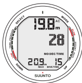
Bild 6.2. Dykdisplay. Aktuell djup är 19,8 m och maxtiden för direktuppstigning är 28 minuter. Maxdjup under dyket var 20,9 meter och förfluten dyktid är 15 minuter.
