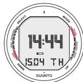
Bild 5.6. Varning för låg batterikapacitet. Batterisymbolen anger att batterikapaciteten är låg och att batteribyte rekommenderas.
