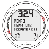
Bild 6.15. Aktivering av Nitrox-läget. Det maximala dykdjupet som baseras på inställt värde för O_2\% (32%) och PO_2 (1,4 bar) är 32,4 m.
