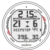
Bild 6.9. Djupstopp. Du ska göra ett djupstopp på 21 meters djup. Sekundvisaren anger att 44 sekunder återstår av djupstoppet.
