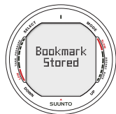
Bild 6.3. Aktivering av bokmärke. En anteckning, eller ett bokmärke, placeras i minnet för dykprofil om du trycker på SELECT under dyket.
