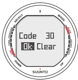
Bild 5.29. Datorn är hoppad på kanal 32. Välj Clear för att ta bort koden, OK för att godkänna den.
