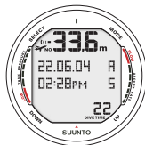
Bild 7.4. Loggbok, sida I. Bläddra genom sidorna för ett visst dyk.
