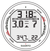
Bild 6.10. Dekompressionsdyk utan djupstopp, under etappgolvet. Uppåtriktad pil, blinkande ASC TIME och en ljudsignal anger att du ska gå uppåt. Minsta sammanlagda uppstigningstid inklusive säkerhetsstopp är 7 minuter. Etapptaket ligger på 3 meter.
