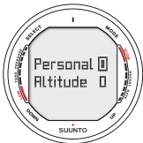
Bild 5.16. Justera inställningen för individuell säkerhetsfaktor och höghöjdsdyk. Tryck på upp-/nedknapparna för att byta läge. Använd Select för att godkänna.
