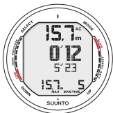
Bild 6.22. Dyk-timern är startad om. Föregående tid var 5 minuter och 23 sekunder. Aktuell tid är 12 sekunder.
