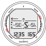
Bild 4.3 Triangeln visar att du befinner dig 120 grader till höger om den låsta bäringen.
