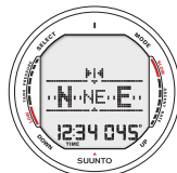
Bild 4.2 Genom att trycka på S-knappen läser du den aktuella bäringen, 45 grader NE.
