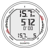
Bild 6.21. Dykning i Gauge-läge. Den aktuella dyk-tiden är 5 minuter och 12 sekunder.
