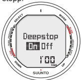
Bild 5.20. Justering av säkerhetsstopp/djupstopp. Tryck på upp-/nedknapparna för att ändra inställning.
