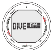
d) Off, dykläget är bortkopplat
