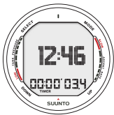
Bild 3.2. Stoppuret visar timmar, minuter, sekunder och tiondels sekunder.
