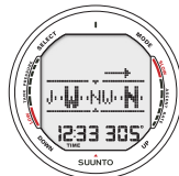
Bild 4.1 Kompassdisplay (från tidsläge). Aktuell riktning är NW, 305 grader. Den lästa bäringen finns på höger sida.
