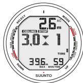
Fig. 6.8 Verplichte Veiligheidsstop. U wordt zeer sterk aangeraden om een één minuut durende Verplichte Veiligheidsstop te maken tussen 6 en 3 m.
