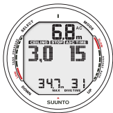
Fig. 6.11. Decompressieduik, boven de ondergrens. Het pijltje is verdwenen en het ASC TIME symbool knippert niet meer.
