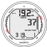
Fig. 6.6. Stijgsnelheidsmeter. Het waarschuwings-sig-naal, de geactiveerde displayverlichting en de knipperende stijgsnelheidsmeter waarschuwen u dat uw stijgsnelheid groter is dan 10 m/min [33 ft/min].
