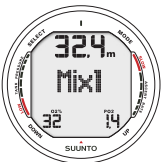
Fig. 5.13. Het instellen van het primaire gasmengsel (MIX1). Het zuurstofpercentage is 32%, de maximale partiële zuurstofdruk is 1.4 bar. De maximum diepte voor dit mengsel is 32.4 meter. Gebruik de UP/DOWN knoppen om het zuurstofpercentage te veranderen en de maximale PO_2 in te stellen. Bevestig de instellingen met SELECT.
