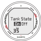
Fig. 5.24 Flesdrukfuncties uit (OFF), druk op UP / DOWN om te activeren. De flesdrukwaarschuwing staat momenteel op 35 bar.
