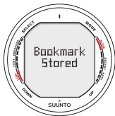
Fig. 6.3. Aandachtspunten plaatsen. Een aandachtspunt, ook wel Bookmark genoemd, kan in het duikprofiel aangebracht worden door op de SELECT knop te drukken.
