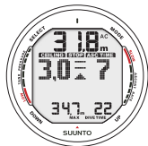
Fig. 6.10. Decompressieduik zonder Deep Stops, beneden de decompressie-ondergrens. De pijl omhoog is zichtbaar, als ook het knipperende ASC TIME symbool. Een akoestisch signaal laat u weten dat u op moet stijgen. De minimale totale opstijgtijd incl. veiligheidsstops is 7 minuten, het decompressieplafond bevindt zich op 3 m [10 ft].
