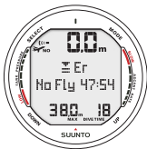
Fig. 6.25. Oppervlaktemodus na een overgeslagen decompressiestop. Het “Er”-symbool geeft aan dat u langer dan 3 minuten lang een decompressieplafond heeft genegeerd. U dient minimaal 48 uur niet te duiken.
