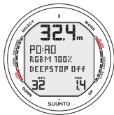
Fig. 6.15. Activering van de Duikmodus (EAN). De maximum duikdiepte (MOD) op basis van het ingestelde O 2 % (32%) en de PO 2 (1.4 bar) is 32.4 m.
