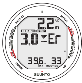
Fig. 6.13. Decompressieduik, boven het deco-plafond. “Er”-waarschuwing plus een alarmsignaal. U dient onmiddellijk af te dalen tot beneden het decompressieplafond.
