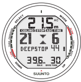
Fig. 6.9 Deep Stop. U wordt aangeraden om een Deep Stop te maken op 21 m. De secondenteller geeft aan dat u op deze diepte nog 44 seconden dient te wachten.
