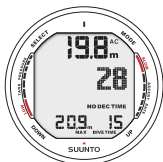
Fig. 6.2. Duikdisplay. De huidige diepte is 19.8 m [66 ft] en de resterende geen-decompressietijd is 28 minuten. De maximum diepte was 20.9 m [70 ft] en de duiktijd is 15 minuten.
