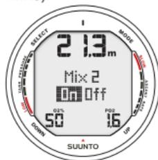
a) MIX 2 est activé. Le pourcentage d'oxygène est de 50%, la limite de la pression partielle est de 1.6 bar. La profondeur maximale autorisée est de 21.3m. Appuyez sur les boutons de défilement pour activer/désactiver MIX2. Appuyez sur Select pour valider les réglages.
