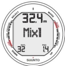
Fig. 5.13. Réglages du 1<sup>er</sup> mélange (MIX1). . Le pourcentage d'oxygène est de 32% et la limite de la pression partielle est de 1.4 bars La profondeur maximale autorisée s'affiche à 32.4 m [106 ft]. Pour changer la valeur d'oxygène et le réglage de pression partielle, appuyez sur les boutons de défilement. Valider les réglages en appuyant sur SELECT.
