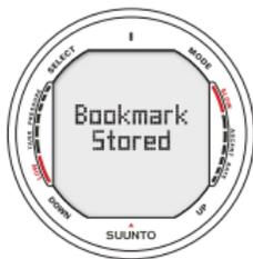
Fig. 6.3. Activation du Repère de Profil. Une annotation, Bookmark (Repère), est placée dans la mémoire de profil durant une immersion en appuyant sur le bouton SELECT.
