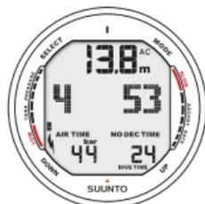
Fig. 6.5. Alarmes de pression de pression d'air. La pression est tombée en dessous de 50 bar (725 psi). L'affichage Pression clignote et une alarme retentit.
