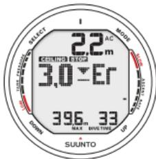
Fig. 6.13. Plongée avec paliers de décompression au-dessus de la zone plafond. La flèche pointe vers le bas, la mention Er apparaît et l'alarme sonore se déclenche. Vous devez immédiatement (dans les 3 minutes) redescendre à la profondeur plafond ou plus bas.
