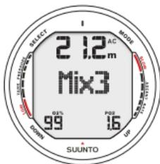
Fig. 6.20. Changer de mélange. La profondeur maximale autorisée est dépassée, le gaz ne peut être sélectionné. La valeur  $PO_2$  clignote.
