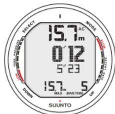
Fig. 6.22. Le chronomètre a été remis à zéro. La dernière étape était de 5 min 23 s. Vous êtes depuis 12 secondes dans l'étape en cours.
