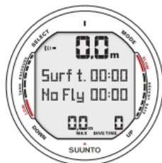
Fig 5.5. Mode Surface. Profondeur et temps de plongée à zéro.
