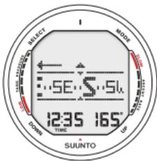
Fig. 4.3. Le triangle indique que vous êtes à 120 degrés sur la droite du cap bloqué.
