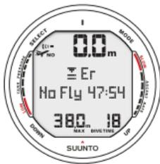
Fig.6.25. Mode Surface après le non-respect d'une procédure de décompression. La mention Er (Erreur) indique que la profondeur plafond a été dépassée pendant plus de trois minutes. Vous ne devez plus plonger pendant au moins 48 heures.
