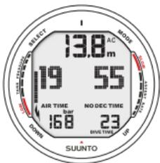
Fig. 6.4. Affichage Plongée. La pression de la bouteille est de 168 bar et le temps restant est de 19 min.
