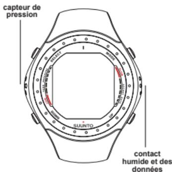
Fig. 2.2 Capteur de profondeur, contacts humides et contacts de transfert de données (B).
