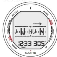
Fig. 4.1. Affichage Compas (depuis le mode TIME). Le cap actuel est Nord Ouest, 305 degrés. Le cap bloqué est sur le côté droit.
