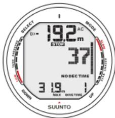
Fig. 6.6. Indicateur de vitesse de remontée. L'alarme sonore, la lumière d'écran et le graphique complet de vitesse de remontée clignotant indiquent que le taux de remontée est de plus 10m/min (33 pieds/min). Il faut ralentir. Le signal STOP signifie que vous devrez effectuer un palier de sécurité obligatoire lorsque la profondeur sera de 6 m (20 pieds).
