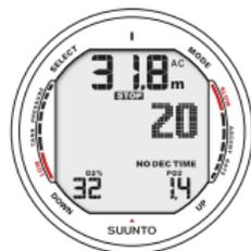
Fig. 6.17. Affichage PO<sub>2</sub>. La pression partielle d'oxygène est 1.4 bar.
