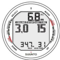
Fig. 6.11. Plongée avec paliers de décompression au-dessus de la profondeur plancher. La flèche pointant vers le haut a disparu et la mention ASC TIME ne clignote plus. Vous êtes dans la zone de décompression.
