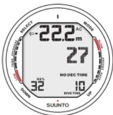
Fig. 6.16. Plongée en mode de Nitrox. Réglage  $O_2\%$  est de 32%.
