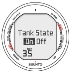
Fig. 5.24 Intégration sans fil désactivée (off). Appuyez sur les boutons de défilement pour l'activer. L'alarme de pression de bouteille est actuellement de 35bar.
