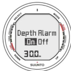
Fig. 5.9. Réglage de l'alarme de profondeur maximale. Appuyez sur les boutons de défilement pour mettre l'alarme sur ON/OFF (activé/désactivé) et régler la profondeur que vous autorisez.
