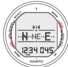
Fig. 4.2. En pressant Select (S) le cap actuel est bloqué, 45 degrés Nord Est
