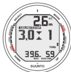
Fig. 6.8. Palier de sécurité obligatoire. Un palier de sécurité obligatoire d'une minute est imposé à une zone de profondeur entre 6 et 3 m (20 et 10 pieds).
