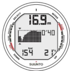
Fig. 7.6. Carnet de plongée, page III. Profil d'une plongée. Appuyez sur Up pour faire défiler.
