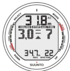
Fig. 6.10. Plongée avec paliers de décompression en dessous de la profondeur plancher. La flèche pointe vers le haut, la mention ASC TIME clignote et l'alarme sonore vous recommande de remonter. La durée totale minimale de remontée incluant le palier de sécurité est de 7 min. La profondeur plafond est à 3 m (10 pieds).
