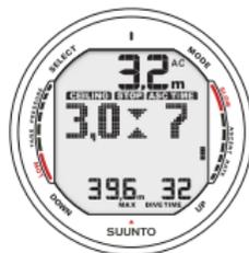
Fig. 6.12. Plongée avec paliers de décompression dans la zone de décompression. Deux flèches se font face ('sablier'). Vous êtes dans la zone de décompression optimale à 3.2 m (11 pieds) et la durée totale de remontée minimum est de 7 min.
