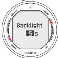
Fig. 3.15 . Réglage du Temps d'Eclairage. Appuyer sur les boutons Up/Down pour changer l'éclairage (on/off) et régler la durée d'éclairage.
