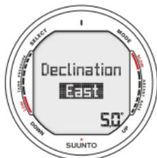
Fig. 4.6. Réglage de la déclinaison
