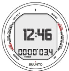
Fig. 3.2. Le chronomètre affiche les heures, les minutes, les secondes et les dixièmes de secondes.
