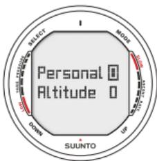
Fig. 5.16. Réglages d'altitude et personnalisés. Appuyez sur les boutons de défilement pour changer les réglages personnalisés. Utilisez SELECT pour valider.
