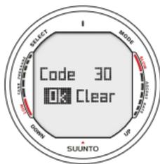
Fig. 5.29 D9 est appairé sur le canal 32. Sélectionnez Clear pour effacer le code, OK pour accepter.
