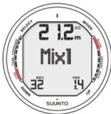
Fig. 6.19 Changer de mélange. Le mélange actuel est le MIX1 (32%). Faites défiler les mélanges possibles en appuyant sur le bouton UP ou DOWN. Sélectionner le nouveau mélange en appuyant sur le bouton SELECT.
