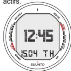
Fig. 2.4. Mode Temps. En appuyant sur le bouton MODE le mode principal est allumé.
