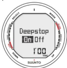
Fig. 5.20 Réglage des paliers de sécurité/ paliers profond. Appuyez sur les boutons de défilement pour changer le réglage.
