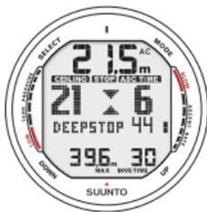
Fig. 6.9. Palier profond. Un palier profond est recommandé à 21 m. Le deuxième indicateur montre qu'il vous reste 44 secondes à effectuer.
