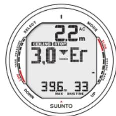
Fig. 6.13. Inmersión con paradas de descompresión, por encima de la profundidad techo. Se visualizan la flecha hacia abajo y la indicación de error Er y se activa la alarma acústica. Debe volver a descender inmediatamente (en un tiempo máximo de 3 min.) a la profundidad techo o por debajo de ésta.
