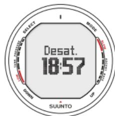
Fig. 7.2. Introducir el Modo de Planificación. Se muestra en pantalla el tiempo de desaturación
