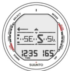
Fig. 4.3. El triángulo indica que se encuentra Ud. a 120 grados a la derecha de la orientación marcada.
