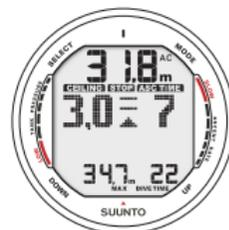
Fig. 6.10. Inmersión con paradas de descompresión sin paradas profundas, por debajo de la profundidad base. Una flecha hacia arriba, la indicación ASC TIME parpadeando y una alarma acústica le indican que ha de ascender. El tiempo total de ascenso mínima incluida parada de seguridad es de 7 minutos. La profundidad techo es de 3 m [10 pies].
