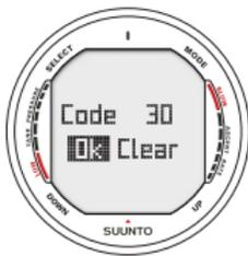
Fig. 5.29 Se acopla la unidad en el canal 32. Seleccione Clear para borrar el código, OK para aceptarlo.
