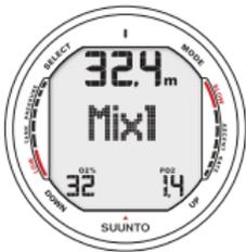
Fig. 5.13. Ajustar la mezcla de gas primario (MIX1). El porcentaje de oxígeno es del 32% y el límite de presión parcial es de 1,4 bar. La profundidad máxima equivalente es de 32,4 m [106 pies]. Pulse los botones de desplazamiento para cambiar el porcentaje de oxígeno y ajustar los valores de la presión parcial de oxígeno. Acepte los ajustes pulsando SELECT.
