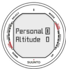
Fig. 5.16. Ajuste de las preferencias personales y la altitud. Para cambiar las preferencias personales pulse los botones de desplazamiento. Para aceptar, pulse SELECT.
