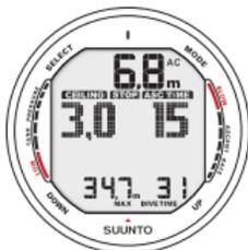
Fig. 6.11. Inmersión con paradas de descompresión, por encima de la profundidad base. La flecha ha desaparecido y la indicación ASC TIME ya no parpadea, lo que significa que se encuentra usted en la zona de descompresión.
