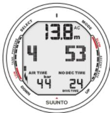
Fig. 6.5. Alarmas de la presión de la botella. La presión ha descendido por debajo de 50 bar [725 psi]. La pantalla de presión parpadea y ha saltado la alarma acústica.
