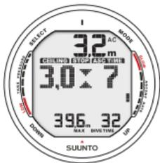
Fig. 6.12. Inmersión con paradas de descompresión, en la zona techo. Las dos flechas están frente a frente ("reloj de arena"). Usted se encuentra en la zona techo de descompresión óptima a 3,2 m [11 pies] y el tiempo total de ascenso mínimo es de 7 minutos.
