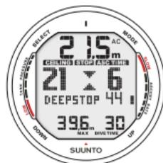
Fig. 6.9 Parada profunda. Se le aconseja realizar una parada profunda a 21 m. El segundo indicador le muestra que dispone de 44 segundos.
