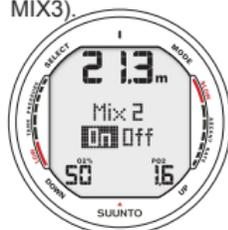
a) Se activa la mezcla MIX 2. El porcentaje de oxígeno es del 50%, el límite de presión parcial de oxígeno es de 1,6 bar. La profundidad operativa máxima es de 21,3 m. Pulse los botones de desplazamiento para activar/desactivar la mezcla MIX 2. Pulse SELECT para aceptar los ajustes.
