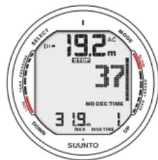
Fig. 6.6. Indicador de la velocidad de ascenso. Se ha activado la alarma acústica. La iluminación de la pantalla y el gráfico que indica la velocidad de ascenso parpadea, es que la velocidad de ascenso es superior a 10 m/min [33 pies/min]. Es necesario reducir la velocidad. La señal STOP significa que se debe realizar una parada de seguridad obligatoria cuando alcance una profundidad de 6 m [20 pies].
