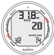
Fig. 6.17. Visualización del  $PO_2$ . La presión parcial de oxígeno es de 1,4 bar
