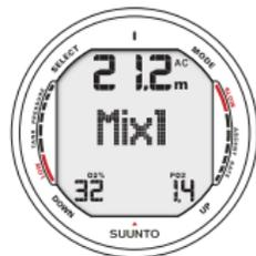
Fig. 6.19 Cambio de mezcla. La mezcla actual es MIX1 (32%). Se puede cambiar de mezcla pulsando los botones [UP] Más o [DOWN] Menos. Seleccione una mezcla nueva pulsando el botón SELECT.
