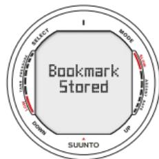
Fig. 6.3. Activación de marcadores. Se produce una anotación, marcador, en la memoria durante la inmersión pulsando el botón SELECT.
