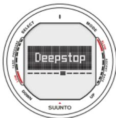
Fig. 5.19. Introducir los ajustes de paradas profundas
