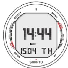
Fig. 5.6. Indicación de pila baja. El símbolo de la pila indica que su nivel está bajo y se recomienda cambiarla.
