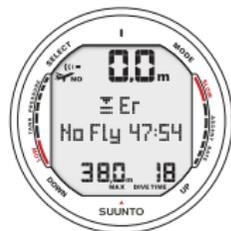
Fig. 6.25. Modo superficie tras no respetar las paradas de descompresión. El símbolo Er indica que no ha respetado la profundidad techo durante más de tres minutos. No debe bucear en, al menos, las próximas 48 horas.
