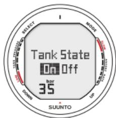
Fig. 5.24 Desactivada la integración inalámbrica (off), pulse Más/ Menos [up/down] para activarla. La alarma de presión de la botella está ajustada, en estos momentos, a 35 bar
