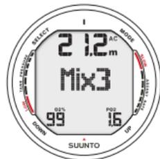
Fig. 6.20 Cambio de mezcla. Se ha sobrepasado la profundidad máxima operativa, no se puede seleccionar la mezcla. Parpadea el valor de  $PO_2$ .
