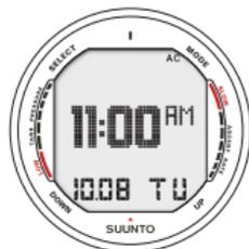
Fig. 2.3. La abreviatura AC indica que los contactos húmedos han sido activados.
