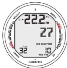
Fig. 6.16. Buceo en modo Nitrox. Ajuste del O<sub>2</sub>% a 32%.
