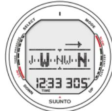
Fig. 4.1. Pantalla de la brújula (del MODO RELOJ [TIME]). El rumbo actual apunta al noroeste, a 305 grados. La marcación cerrada está a la derecha.
