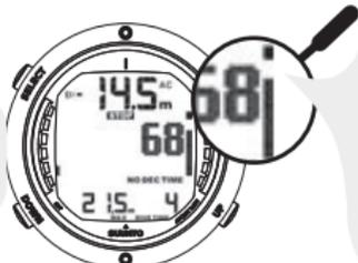
LA ACTIVACIÓN DE LA ILUMINACIÓN, LA ALARMA Y EL PARPADEO DE LA BARRA GRÁFICA DE VELOCIDAD DE ASCENSO INDICAN QUE ESTÁ ASCENDIENDO A UNA VELOCIDAD SUPERIOR A LOS 10 m/min. SE RECOMIENDA QUE HAGA UNA PARADA DE SEGURIDAD OBLIGATORIA AL LLEGAR A UNA PROFUNDIDAD DE 6 m.
