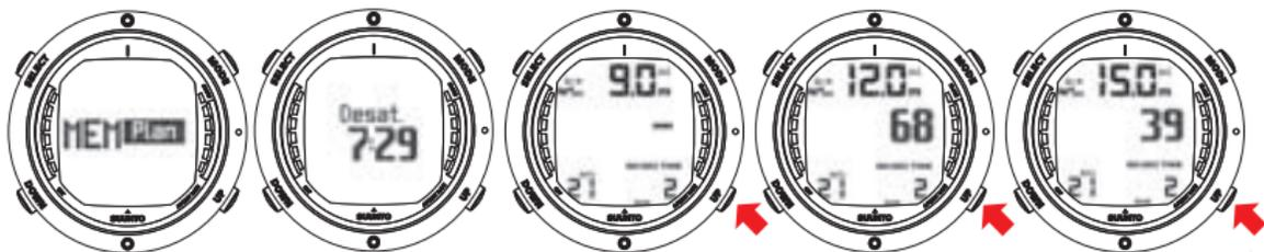
AL ENTRAR EN EL MODO MEMPLAN, LA PANTALLA MUESTRA BREVEMENTE EL TIEMPO DE DESATURACIÓN RESTANTE ANTES DE ENTRAR EN EL MODO PLAN. UTILICE LOS BOTONES UP Y DOWN PARA VER LOS DISTINTOS LÍMITES SIN DESCOMPRESIÓN. LOS LÍMITES SIN DESCOMPRESIÓN SUPERIORES A LOS 99 MINUTOS SE REPRESENTAN CON “-”.
