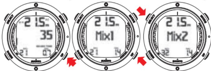
CAMBIO DE MEZCLA DE GASES. PARA CAMBIAR ENTRE LAS MEZCLAS ACTIVADAS, PRESIONE LOS BOTONES UP O DOWN. PARA SELECCIONAR UNA NUEVA MEZCLA, PRESIONE EL BOTÓN SELECT.
