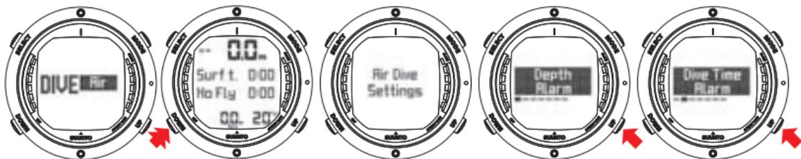
UTILICE LOS BOTONES UP Y DOWN PARA CAMBIAR DE UN AJUSTE DE BUCEO A OTRO.
