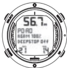
ACTIVACIÓN DEL MODO DE INMERSIÓN DE NITROX. LA PROFUNDIDAD OPERATIVA MÁXIMA, BASADA EN LOS AJUSTES DE  $O_2\%$  (21%) Y  $PO_2$  (1,4 BARES) ES DE 56,7 m.
