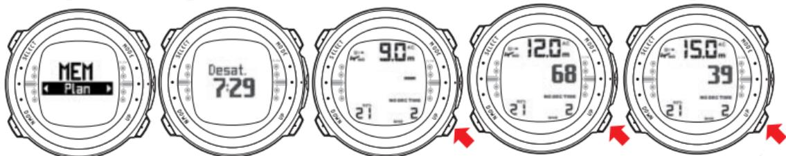
BEIM AUFRUFEN DES MODUS MEMPLAN WIRD ZUNÄCHST KURZ DIE RESTENTSÄTTIGUNGSZEIT ANGEZEIGT BEVOR DER PLANUNGSMODUS STARTET. VERSCHIEDENE NULLZEITGRENZEN MIT UP/DOWN-TASTEN WÄHLEN. NULLZEITEN ÜBER 99 MINUTEN WERDEN ALS "—" ANGEZEIGT.
