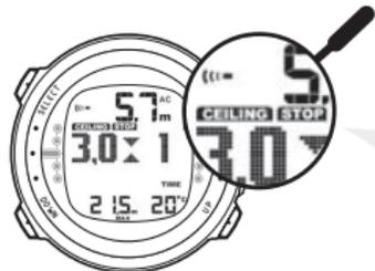
BEI ANZEIGE VON CEILING UND STOP VERBINDLICHEN SICHERHEITSSTOPP IN DER DEKOZONE ZWISCHEN 6 M UND 3 M EINLEGEN.
