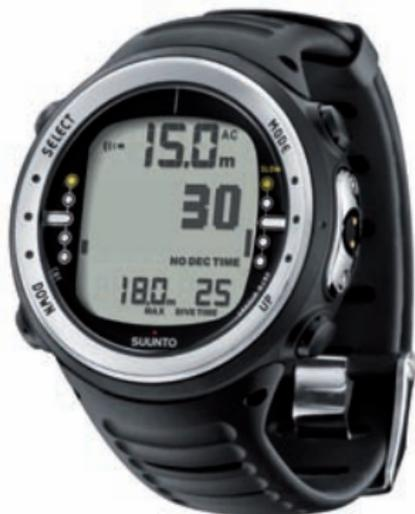
Dank des Suunto D4 wird Ihr Tauchgang unkomplizierter, da alle Daten zu Tiefe, Zeit und Dekompressionsstatus auf einem einzigen, übersichtlichen Bildschirm angezeigt werden.
