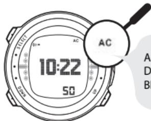
IN DER OBEREN RECHTEN ECKE DER ANZEIGE WIRD AC ANGEZEIGT, WENN DER TAUCHCOMPUTER MIT WASSER IN BERÜHRUNG IST. DIES AKTIVIERT AUCH DEN DIVE-MODUS.
