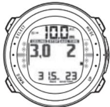
DER NACH OBEN WEISENDE PFEIL IST ERLOSCHEN UND DIE ANZEIGE ASC TIME HAT AUFGEHÖRT ZU BLINKEN. DIES BEDEUTET, DASS SIE DEN DEKOMPRESSIOBEREICH ERREICHT HABEN.
