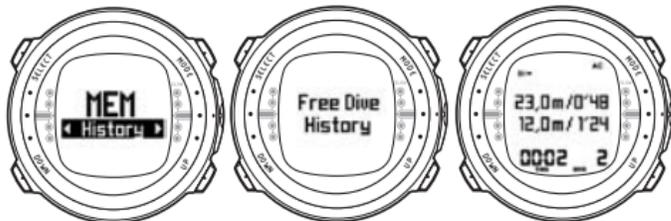
Die Freitauchgang-Übersicht fasst die gesamte Sequenz der Freitauchgänge zusammen. Im Gegensatz zur Tagesübersicht wird die Übersicht der Freitauchgänge nicht automatisch zurückgesetzt.
