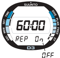
Bild 4.9. Tiden för nedräkningsuret och repetitionsfunktionen visas.
