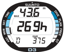
Bild 5.9. Minne för dykhistorik, mätläge. Totalt antal dyk, antal dyktimmar och maxdjup.
