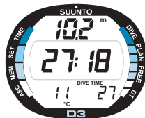
Bild 3.18. Dykdisplay. Aktuellt djup är 10,2 meter. Dyktidsräknaren visar 27 minuter och 18 sekunder. Temperaturen och dyktiden visas längst ned.
