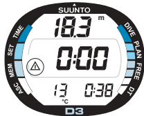
Bild 3.8. Aktivering av bokmärke. En anteckning, eller ett bokmärke, placeras i minnet för dykprofil om du trycker på S under dyket (en varningssymbol visas).
