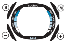
Bild 2.1. Tryckknapparna på D3.
