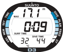
Bild 3.21. Display för ytintervall. Du har kommit till ytan efter ett 44 minuter långt dyk, där maxdjupet var 17,1 meter.
