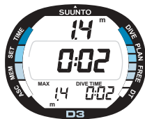
Bild 3.11. Fridyk. Aktuellt djup är 1,4 meter och dyktiden är 2 sekunder.
