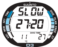
Bild 3.20. Indikator för uppstigningshastigheten. SLOW blinkar, fyra segment visas och en ljudsignal hörs. Uppstigningshastigheten är över 10 m/min.
