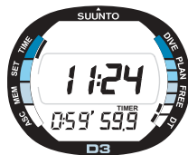
Bild 2.9. Nedräkningsuret räknar ned från en förinställd tid och lägesindikatorn DT blinkar.
