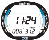
Bild 2.7. Stoppuret visar timmar, minuter och sekunder.
