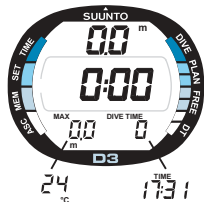
Bild 3.5. Igångsättning III. Ytläge (Gauge). Djup och dyktid är noll. Om du trycker på +/- aktiveras den alternativa displayen med maxdjup och aktuell tid.
