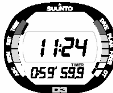
Fig. 2.9 A contagem regressiva inicia a partir de uma hora ajustada e o indicador DT pisca.
