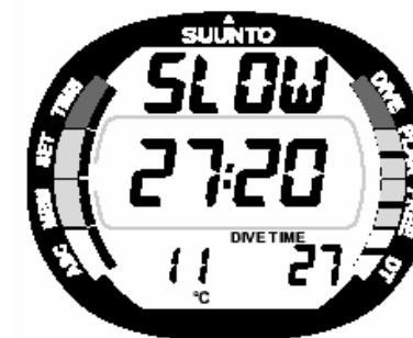
Fig. 3.20. Indicador da Velocidade de Ascensão. O texto SLOW , 4 segmentos piscando e um sinal sonoro indicam que a velocidade de ascensão ultrapassou 10 m/min.
