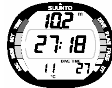
Fig. 3.18. Mostrador. A profundidade atual é de 10,2 metros. O tempo de mergulho é de 27 minutos e 18 segundos. A temperatura e o tempo de mergulho são mostrados na janela inferior.
