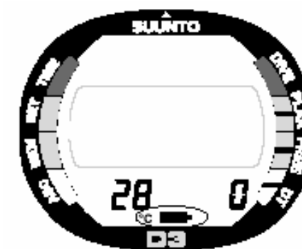
Fig. 3.7. Aviso de Bateria Fraca. O símbolo de bateria indica que a bateria está fraca
