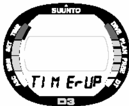
Fig. 2.6 A função de cronometro é indicada pelo texto TIMER e o indicador de modo
