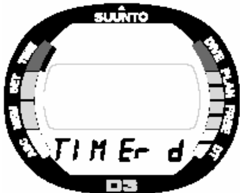
Fig. 2.8. O texto TIMER d na parte inferior do mostrador, e o modo indicador – TIME – do lado esquerdo do mostrador indicam que você está no modo de contagem regressiva
