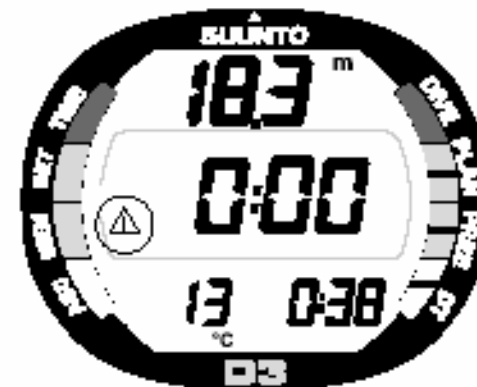
Fig. 3.8. Ativação do Marcador. Uma anotação é feita na memória do perfil durante o mergulho, pressionando o botão S.
