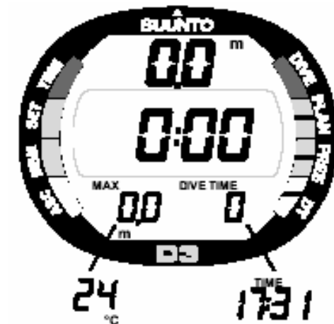
Fig. 3.5. Inicialização III. Modo de Superfície (GAUGE). A profundidade e o tempo de mergulho é igual a zero. Pressione os botões + ou - para ativar as informações alternativas de profundidade máxima e a hora atual
