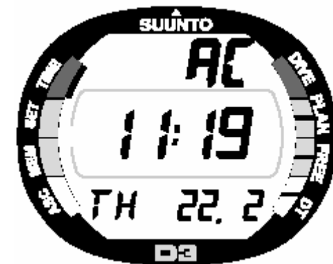
Fig. 2.3 Os contatos de água ativados são indicados pelo texto AC
