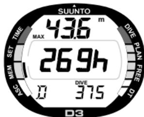
Fig. 5.9. Memoria Storica immersioni con profondimetro. Numero totale di immersioni, ore d'immersione e massima profondità raggiunta.
