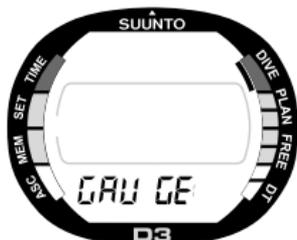
Fig. 3.1. Selezione modalità Immersione con profondimetro (GAUGE).
