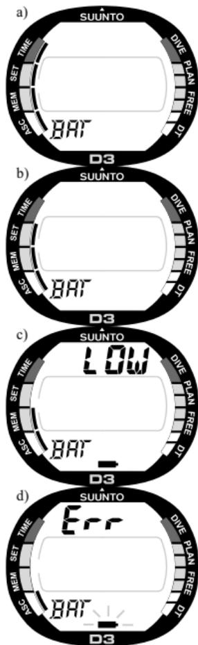
Fig. 3.4. Avvio II. Indicatore di carica della batteria.
