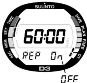
Fig. 4.9. Selezione ora del conteggio alla rovescia e ripetizione allarme.
