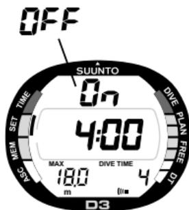
Fig. 4.14. Allarme di Tempo d'Immersione. La finestra centrale visualizza un tempo inferiore ai cinque minuti.
