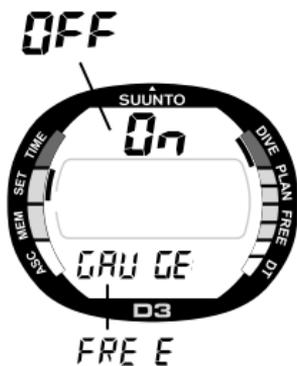
Fig. 4.11. Imposta modalità Gauge/Free. Attiva/Disattiva lampeggiamento.
