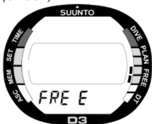
Fig. 3.2. Selezione modalità Immersione in apnea (FREE).
