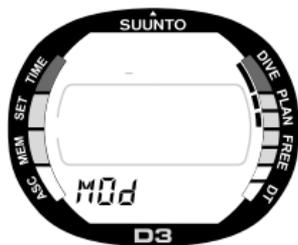
Fig. 3.15. Pianificatore profondità massima operativa. La modalità di pianificazione viene indicata dalla voce MOD e dall'indicatore di modalità.
