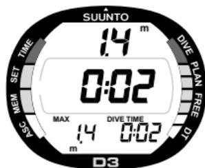
*Fig. 3.11. Immersioni in apnea. Profondità corrente pari a 1.4 metri e durata immersione pari a 2 secondi.*
