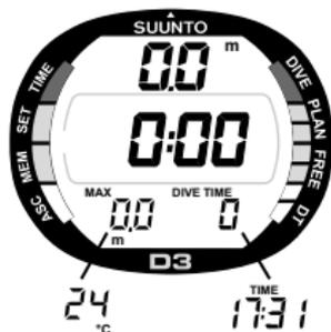
Fig. 3.5. Avvio III. Modalità Superficie (Modalità Gauge). I tempi di immersione e la profondità sono pari a zero. Premendo i tasti + e - si attiva il display alternativo della profondità massima e dell'orologio.
