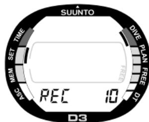
*Fig. 4.12. Selezione intervallo di registrazione del profondimetro.*
