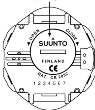
Fig. 6.1. Coperchio del vano batteria
