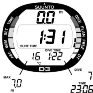
Fig. 3.14. Display superficie dopo un'immersione in apnea. Il display centrale visualizza il tempo trascorso in superficie.
