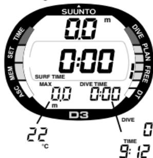
Fig. 3.6. Avvio IV. Modalità apnea. I tempi di immersione e la profondità sono pari a zero. Premendo i tasti + e - si attivano i display alternativi.
