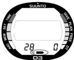
Fig. 3.7. Induttore di bassa carica. Il simbolo della batteria indica che la batteria è quasi scarica. Si raccomanda di sostituirla.
