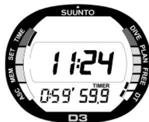
Fig. 2.9. Il cronometro effettua il conteggio alla rovescia nei confronti di un determinato tempo preimpostato. L'indicatore modalità **DT** lampeggia.
