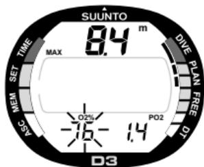
Fig. 3.16. Il Mod del profonditàmetro visualizza la profondità operativa massima e i valori corrispondenti di  $O_2\%$  e  $PO_2$ .
