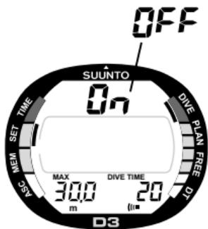
Fig. 4.15. Allarme di tempo d'immersione. Display con più di cinque minuti residui di immersione.
