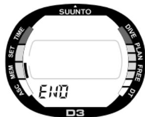
Fig. 5.7. Registro, raggiunta fine memoria immersioni. La voce END appare tra la prima e l'ultima immersione.
