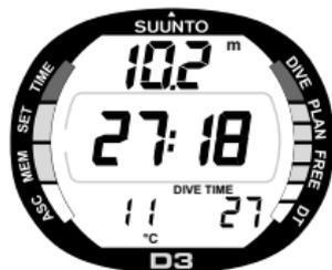
Fig. 3.18. Display immersione. Profondità corrente pari a 10,2 metri. Il cronometro dell'immersione visualizza 27 minuti e 18 secondi. La temperatura e la durata dell'immersione sono visualizzati nella parte bassa del display.
