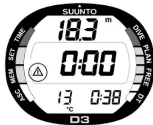
Fig. 3.8. Attivazione funzione annotazione punti importanti (Bookmark). Premendo il tasto **S** durante un'immersione, si colloca un'annotazione di fianco alla memoria di profilo (visualizzata con il simbolo di attenzione per il sub).
