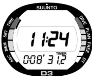
Fig. 2.7. Il cronometro visualizza le ore, i minuti e i secondi.
