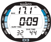
Fig. 3.21. Affichage de la surface. Vous revenez d'une plongée de 44 min à une profondeur maxi de 17,1m.
