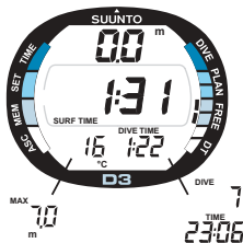
Fig. 3.14. Affichage au retour d'une apnée. Au centre le temps passé en surface.
