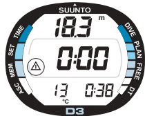
Fig. 3.8 Activation du marqueur. Pendant la plongée une annotation ou un marqueur peut-être placé sur la mémoire du profil en appuyant sur la bouton S (le signe attention s'affiche).
