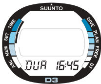
Kuva 4.5. Kaksoiskellonajan näyttö valitaan. Näyttö III.
