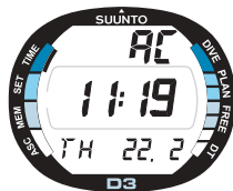
Kuva 2.3. Aktivoitu vesikontakti ilmaistaan tekstillä AC.
