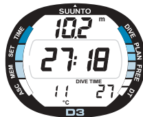
Kuva 3.18. Sukellusnäyttö. Tämänhetkinen syvyys on 10,2 m. Sukellusaika on 27 minuuttia ja 18 sekuntia. Lämpötila ja sukellusaika näytetään alaikkunassa.
