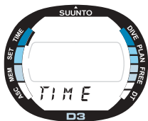
Kuva 2.4. Kellonajan toimintotilassa näkyy teksti TIME sekä tilan osoitin.
