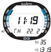
Kuva 2.5. Kellonajan näyttö a) näytöllä on päiväys b) sekunnit näkyvät c) kaksoisaika näytetään.
