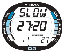
Kuva 3.20. Nousunopeuden osoitin. Vilkkuva SLOW ja neljä segmenttiä näytetään yhdessä äänihälytyksen kanssa. Nousunopeus on suurempi kuin 10 m/min.
