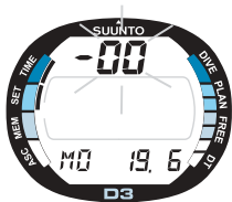
Kuva 4.4. Vuosi, kuukausi ja päivä valitaan. Näyttö II.
