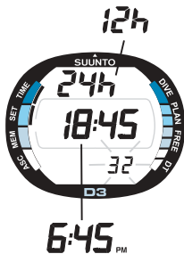
Kuva 4.3. Kellonajan asetustila aktivoituu ja sekunnit vilkkuvat. Näyttö I.
