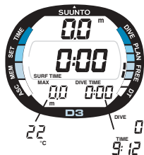
Kuva 3.6. Käynnistys IV. Vapaasukellustila. Syvyys ja sukellusaika ovat nolla. Painamalla +/- painiketta pääset vuorottelevaan näyttöön, jolla näytetään enimmäissyvyys sekä tämänhetkinen kellonaika.
