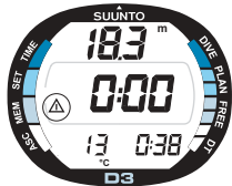
Kuva 3.8. Merkintätoiminnon aktivoiminen. Merkintä kirjataan sukelluksen aikana profiilimuistiin painamalla S -painiketta (Näytöllä näkyy Sukelluksen huomiomerkki.)
