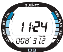
Kuva 2.7. Ajanoton näytössä näytetään tunnint, minuutit ja sekunnit.
