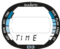
Fig. 2.4. La indicación TIME y el indicador de modo informan de que los contactos húmedos están activados.
