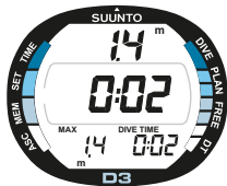
Fig. 3.11. Apnea. La profundidad real es de 1,4 m., y el tiempo de inmersión de 2 segundos.
