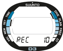
Fig. 4.12. Intervalo de registro seleccionado.
