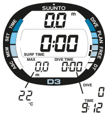
Fig. 3.10. Visualización en Superficie / visualizaciones alternativas.
