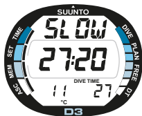
Abb. 3.20. Aufstiegsgeschwindigkeitsanzeige. Blinkendes SLOW und 4 Segmente werden angezeigt, ein akustischer Alarm ertönt. Die Aufstiegsgeschwindigkeit ist höher als 10m/ min [33ft/ min].
