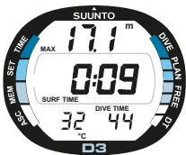
Abb. 3.21. Oberflächen-Anzeige. Sie sind von einem 44 minütigen Tauchgang aufgetaucht mit einer maximalen Tiefe von 17.1m.
