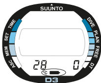
Abb. 3.7. Batteriewarnung. Das Batteriesymbol zeigt eine geringe Batteriespannung an. Die Batterie sollte ersetzt werden.
