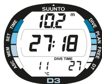
Abb. 3.18. Anzeige während des Tauchgangs. Die aktuelle Tiefe beträgt 10.2m. Die Tauchzeit beträgt 27 Minuten und 18 Sekunden. Temperatur und Tauchzeit werden im unteren Displayfenster angezeigt.
