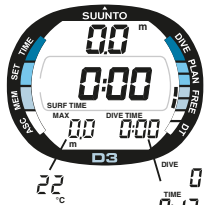
Abb. 3.6. Startupdisplay IV. Freitauch-Modus. Die Werte für Tiefe und Zeit betragen Null. Durch Drücken von + oder - wird abwechselnd die Anzeige der Maximaltiefe und der aktuellen Tauchtiefe aktiviert.
