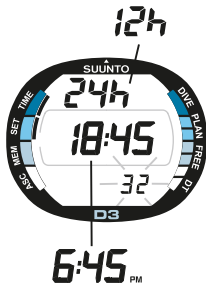
Abb. 4.3. Der Modus zur Zeitanzeige ist aktiv und die zweiten Ziffern blinken. Seite I.
