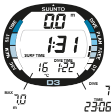
Abb. 3.14. Oberflächeanzeige nach einem Freitauchgang. Das mittlere Displayfenster zeigt die Oberflächenzeit.
