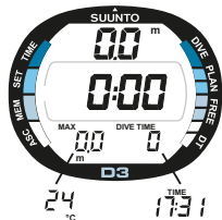
Abb. 3.5. Startupdisplay III. Oberflächen-Modus (Tiefenmesser). Die Werte für Tiefe und Zeit betragen Null. Durch Drücken von + oder - wird abwechselnd die Anzeige der Maximaltiefe und der aktuellen Tauchtiefe aktiviert.
