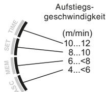
Abb. 3.19. Aufstiegs­geschwindigkeits­anzeige. Die Segmente weisen auf die Aufstiegs­geschwindigkeit hin.
