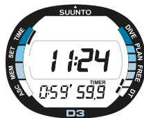
Abb. 2.9. Die Countdown-Anzeige zählt von einer voreingestellten Zeit rückwärts und die Modusanzeige DT blinkt.
