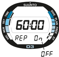
Abb. 4.9. Der Einstellmodus für die Countdown-Anzeige und wiederholten Alarm sind ausgewählt.
