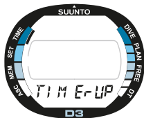
Abb. 2.6. Die Funktion „Stopuhr“ wird durch den Text TIMER UP und die Modusanzeige signalisiert.
