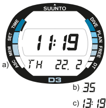
Abb. 2.5. Zeitanzeige a) Anzeige des Datums b) Anzeige der Sekunden c) Anzeige der 2. Zeitzone
