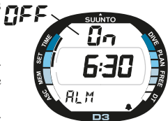
Abb. 4.7. Der Einstellmodus für den täglichen Alarm ist aktiviert.
