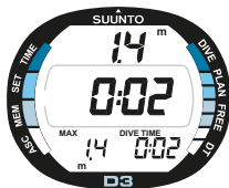
Abb. 3.11. Freitauchgang. Die aktuelle Tiefe beträgt 1.4m, die Tauchzeit 2 Sekunden.
