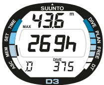
Abb. 5.9. Tauchgangshistorie. Zahl der Tauchgänge, Tauchstunden und maximale Tiefe.
