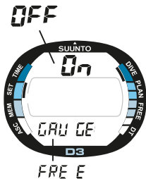
Abb. 4.11. Einstellmodus Tiefenmesser/ Freitauchen. Aktivierungs-/ Deaktivierungsstatus blinkt.
