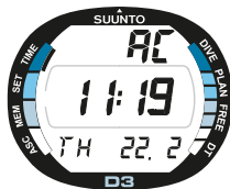
Abb. 2.3. Die Aktivierung des Wasserkontakts wird durch den Text „AC“ dargestellt.
