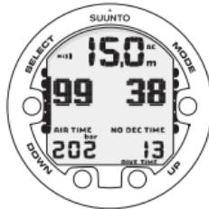
Изменение вашего потребления воздуха определяется по измерениям давления с постоянными интервалами в одну секунду за периоды длительностью 30–60 секунд. Повышение потребления воздуха вызывает более быстрое уменьшение времени, определяемого по запасу воздуха, в то время как снижение потребления медленно увеличивает это время. Это позволяет избежать чрезмерно оптимистических оценок времени, определяемого по остатку воздуха, в случае временного сокращения его потребления.
