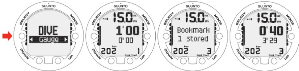
НАЖАТИЕ КНОПКИ SELECT ВО ВРЕМЯ ПОГРУЖЕНИЯ ВЫЗЫВАЕТ ЗАПИСЬ ЗАКЛАДКИ В ПАМЯТЬ ПРОФИЛЯ, СБРОС ВРЕМЕНИ ПОГРУЖЕНИЯ, И НИЖЕ ОТОБРАЖАЕТСЯ РАНЕЕ ИЗМЕРЕННЫЙ ИНТЕРВАЛ ВРЕМЕНИ.
