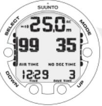
КНОПКА DOWN ПООЧЕРЕДНО ОТБРАЖАЕТ ЗНАЧЕНИЯ О<sub>2</sub>, МАКСИМАЛЬНОЙ ГЛУБИНЫ, ДАВЛЕНИЯ В БАЛЛОНЕ И ТЕКУЩЕГО ВРЕМЕНИ.
