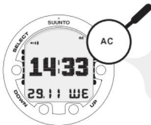
СИМВОЛ AC ОТДОБРАЖАЕТСЯ В ПРАВОМ ВЕРХНЕМ УГЛУ ДИСПЛЕЯ ПРИ КОНТАКТЕ ПОДВОДНОГО КОМПЬЮТЕРА С ВОДОЙ.
