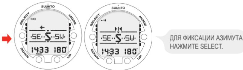
Подводный компьютер Suunto Cobra3 также помогает при навигации по квадратным и треугольным маршрутам, а также при навигации обратным курсом. Для этого применяются следующие графические символы, расположенные в центре дисплея компаса:
