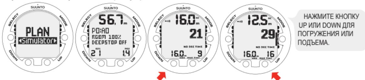
Этот режим может также использоваться для добавления требуемых интервалов на поверхности к моделируемым погружениям. Добавьте требуемую длительность интервала на поверхности к текущему значению интервала на поверхности нажатием кнопок UP и DOWN.
