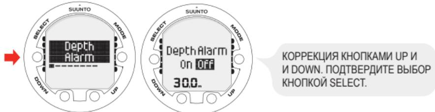
Настройка сигнала тревоги по глубине установлена на заводе-изготовителе равной 30 м/100 футам, однако вы можете изменить ее в соответствии с личными предпочтениями или выключить. Допускается установка значения глубины в диапазоне от 3 до 100 м / от 9 до 328 футов.
