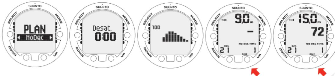
ПРИ ВХОДЕ В РЕЖИМ PLANNODEC НА ДИСПЛЕЕ СНАЧАЛА КРАТКОВРЕМЕННО ОТОБРАЖАЕТСЯ ОСТАВШЕЕСЯ ВРЕМЯ РАССЫЩЕНИЯ ПЕРЕД ПЕРЕХОДОМ В РЕЖИМ ПЛАНРИРОВАНИЯ. ИСПОЛЬЗУЙТЕ КНОПКИ UP И DOWN ДЛЯ ПРОКРУТКИ РАЗЛИЧНЫХ БЕЗДЕКОМПРЕССИОННЫХ ПРЕДЕЛОВ. ПРЕДЕЛЫ ПОГРУЖЕНИЯ БЕЗ ДЕКОМПРЕССИОННЫХ ОСТАНОВОК СВЫШЕ 99 МИНУТ ОТОБРАЖАЮТСЯ СИМВОЛОМ «—».
