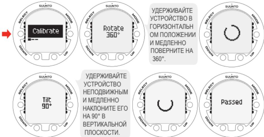
Повторные нарушения калибровки могут свидетельствовать о том, что вы находитесь вблизи от источников сильного магнитного поля, таких как крупные металлические предметы, линии электропитания или электрические приборы. После перемещения в другое место попробуйте выполнить калибровку компаса еще раз. Если калибровка по-прежнему не выполняется, свяжитесь с авторизованным сервисным центром компании Suunto.
