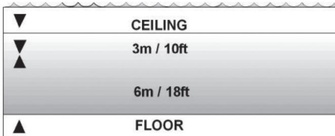
Глубина потолка и пола зависит от профиля вашего погружения. При входе в режим погружения с декомпрессией глубина потолка будет относительно небольшой, однако если вы продолжите нахождение на глубине, это значение будет опускаться вниз, а время подъема – увеличиваться. Аналогично, значения потолка и пола могут изменяться по направлению к поверхности по мере вашей декомпрессии.
