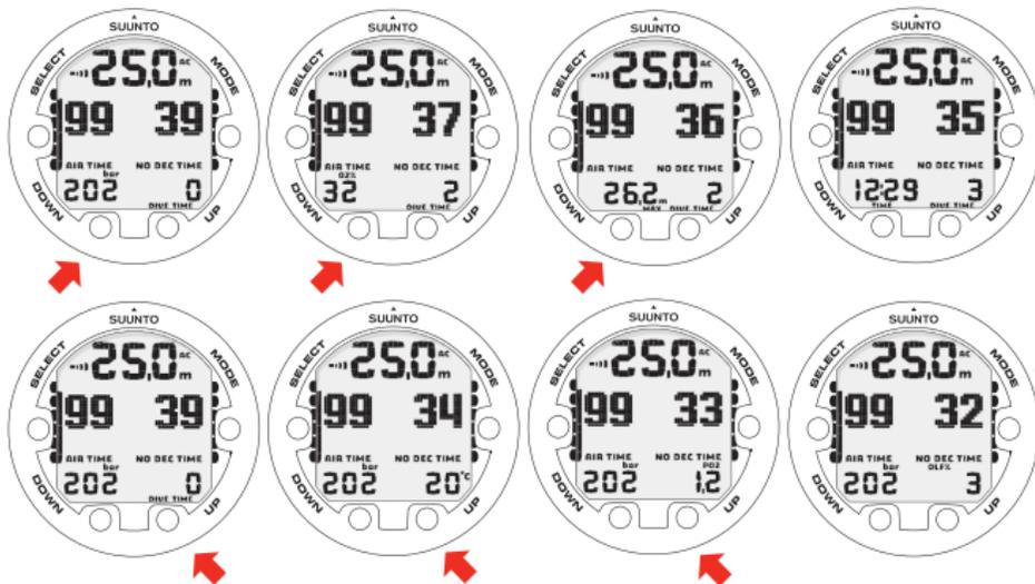
O BOTÃO DOWN ALTERNA ENTRE O<sub>2</sub>, PRESSÃO DO TANQUE DE PROFUNDIDADE MÁXIMA E A HORA ACTUAL.
