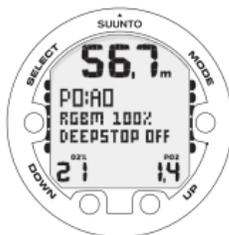
ACTIVAÇÃO DO MODO DE MERGULHO NITROX. PROFUNDIDADE OPERACIONAL MÁXIMA BASEADA EM O<sub>2</sub>% (21%) E PO<sub>2</sub> (1,4 BARS) É DE 56,7 M.
