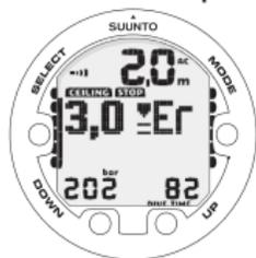
MERGULHO DE DESCOMPRESSÃO, ACIMA DO LIMITE SUPERIOR. NOTE A SETA A APONTAR PARA BAIXO, ALARME E AVISO ER. DEVE DESCER IMEDIATAMENTE (NO PRAZO DE 3 MINUTOS) PARA O, OU ABAIXO DO, LIMITE SUPERIOR.
