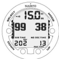
INDICAÇÃO DE MERGULHO - A PROFUNDIDADE ACTUAL É DE 15 M, O TEMPO LIMITE DA PARAGEM DE NÃO-DESCOMPRESSÃO É DE 38 MIN. O TEMPO DE MERGULHO DECORRIDO É DE 13 MIN. 99 MINUTOS DO TEMPO DE AR RESTANTE E 202 BARS DA PRESSÃO DO TANQUE.
