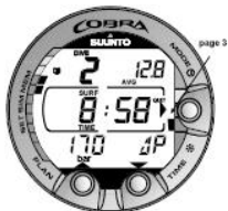
Figura 7.7. Livro de registos, página III. Intervalo de superfície, profundidade média e ar consumido indicados por \Delta P .
