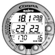
Figura 6.16. O segmento mais baixo do gráfico de barras fica intermitente para indicar que o valor OLF apresentado se refere a OTU.
