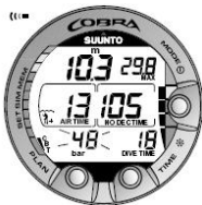
Figura 6.5. Avisos da pressão da botija. A pressão desceu, sendo inferior a 50 bar /725 psi. Existe uma informação intermitente sobre a pressão e um alarme sonoro.
