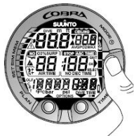
Rysunek 5.5. Uruchamianie I. Wszystkie segmenty widoczne.
