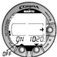
Rysunek 4.6. Wprowadzanie ustawień alarmu dziennego (budzika) [3 T ALARM]
