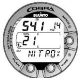
Figura 6.13. Visualizzazione Nitrox. Massima profondità in base alla % di  $O_2$  (21%) e  $PO_2$  (1,4 bar): 54,1 m/177 piedi.
