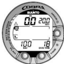
Figura 7.1. Display Superficie. Si è riemersi da un'immersione di 18 minuti, la cui profondità massima è stata di 20,0 m/66 piedi. La profondità attuale è 0,0 m/0 piedi. Il simbolo dell'aereo indica che è opportuno non volare e il simbolo di attenzione per il sub indica che sarebbe opportuno prolungare il proprio tempo di intervallo di superficie.
