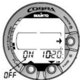
Figura 4.6. Regolazione della modalità di Impostazione dell'allarme giornaliero [3 T ALARM]
