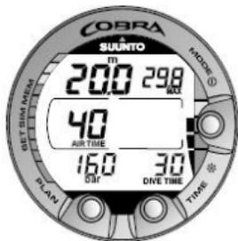
Figura 6.17. La modalità Gauge. Durante l'immersione vengono visualizzati la profondità attuale, la profondità massima, il tempo di immersione, la pressione della bombola, il tempo d'aria rimanente e l'indicatore della velocità di risalita.
