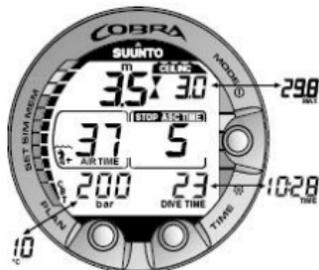
Figura 6.11. Immersione con decompressione, in zona ceiling. Due frecce rivolte una verso l'altra ("clessidra"). Si raggiunge la zona del massimale ottimale a 3,5 m/11 piedi e il tempo di risalita minimo è di 5 minuti. Premendo il pulsante TIME si attiva il display alternativo.
