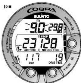
Figura 5.8. Indicatore della velocità di risalita. Due segmenti.
