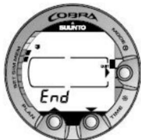
Figura 7.4. Registro, fine della memoria. Tra l'immersione più vecchia e quella più recente viene visualizzata la scritta END (fine).
