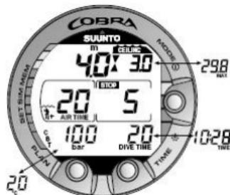
Figura 5.9. Una sosta di sicurezza obbligatoria. Si consiglia all'utente di effettuare una sosta di sicurezza obbligatoria nella zona di profondità compresa tra 6 m e 3 m/20 e 10 piedi. Premere il pulsante TIME per visualizzare il display alternativo.
