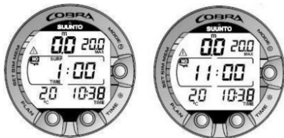
Figura 7.2. I display di intervallo di superficie, tempo di superficie e tempo di non volo: Premendo una volta il pulsante TIME viene visualizzato il display di tempo di superficie e premendo due volte il pulsante TIME viene indicato quello del tempo di non volo, indicato dal simbolo di un aereo.
