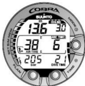
Figura 6.10. Immersione con decompressione, al di sopra del floor. La freccia verso l'alto è scomparsa e l'indicazione ASC TIME ha smesso di lampeggiare: questo significa che ci si trova all'interno dell'intervallo di decompressione.
