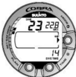
Figura 7.10. Informazioni sull'archivio delle immersioni. Numero totale di immersioni, ore di immersione e profondità massima.
