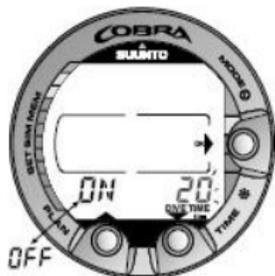
Figura 5.2. Impostazione dell'Allarme di tempo d'immersione Premere i pulsanti di scorrimento per attivare/disattivare l'allarme e impostare il valore del tempo d'immersione.
