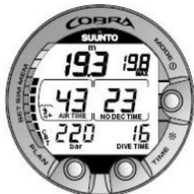
Figura 6.2. Display di immersione. La profondità attuale è di 19,3 m/63 piedi e il limite di tempo della sosta di non decompressione è di 23 minuti in modalità A0/P1. La profondità massima durante questa immersione è stata di 19,8 m/65 piedi, il tempo di immersione trascorso è di 16 minuti.
