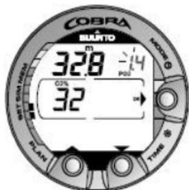
Figura 5.4. Impostazione della percentuale e della pressione parziale di ossigeno. La profondità massima equivalente viene visualizzata come 32,8 m/107 piedi. Premere i pulsanti di scorrimento per cambiare la percentuale di ossigeno e per impostare il valore di impostazione parziale dell'ossigeno.
