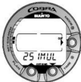
Figura 7.11. Opzioni di simulazione delle immersioni [2 SIMUL]
