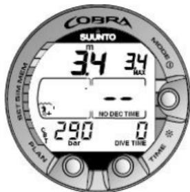
Figura 6.1. L'immersione ha appena avuto inizio e non compare alcun tempo d'aria. Il primo calcolo dell'autonomia d'aria residua comparirà dopo 30-60 secondi.
