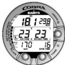
Figura 6.16. Il grafico a barre più in basso lampeggia per indicare che il valore OLF mostrato si riferisce all'OTU.
