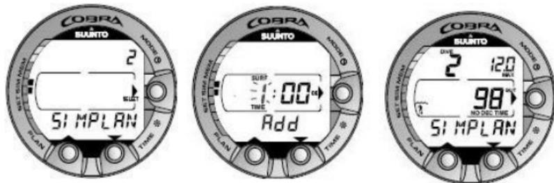
Figura 7.13. Modalità Simulatore di pianificazione di immersione [2 SIMPLAN]. Aggiungere l'incremento per gli intervalli di superficie desiderato (all'intervallo di superficie attuale) premendo i pulsanti TIME e PLAN. Questo display viene mostrato solo per le immersioni ripetitive.
