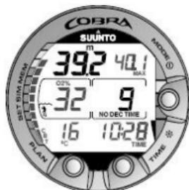
Figura 6.15. Display alternativo. Premendo il pulsante TIME vengono visualizzati l'ora attuale, la profondità massima, la temperatura, il CBT e la % di O2 se il Tempo d'aria è inferiore a 30 minuti.
