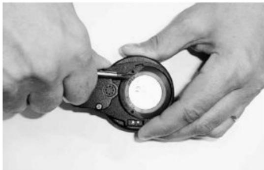
Figura 9.1. Apertura dell'anello di bloccaggio.
