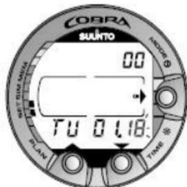
Figura 4.5. Regolazione della modalità di Impostazione della data [2 AdJ DATE].
