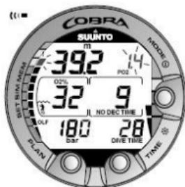
Figura 6.14. Display della pressione parziale di ossigeno e dell'OLF. Viene emesso un allarme acustico quando la pressione parziale di ossigeno è maggiore di 1,4 bar o del valore impostato e/o l'OLF ha raggiunto il limite dell'80%.
