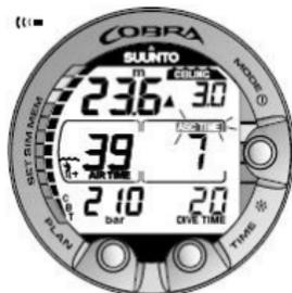
Figura 6.9. Immersione con decompressione, al di sotto del floor. La freccia verso l'alto, l'indicazione del tempo di risalita che lampeggia e un allarme sonoro indicano che è necessario risalire. Il tempo di risalita totale minimo, con sosta di sicurezza, è di 7 minuti. Il massimale è a 3 m/10 piedi.
