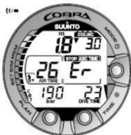
Figura 6.12. Immersione con decompressione, al di sopra del massimale. Si noti la freccia rivolta verso il basso, una scritta Er e un allarme sonoro. È necessario scendere immediatamente (entro 3 minuti) al livello del massimale o a una profondità maggiore.
