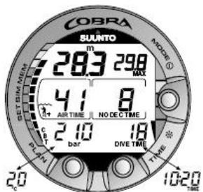
Figura 6.3. Display di immersione. L'attuale pressione della bombola è di 210 bar/3.045 psi e il tempo d'aria rimanente è 41 minuti. Dopo aver premuto il pulsante TIME vengono mostrate alternativamente l'ora corrente e la temperatura per 5 secondi.
