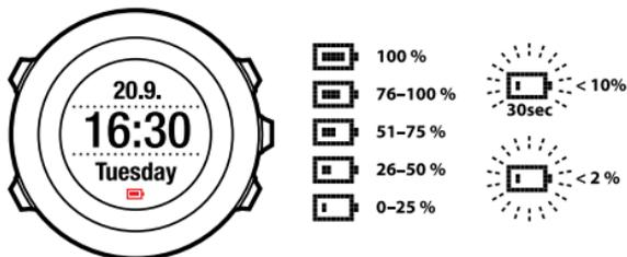
Laden Sie die Batterie wieder auf, indem Sie das Gerät über das Suunto-USB-Kabel mit Ihrem Computer verbinden, oder verwenden Sie das USB-kompatible Suunto-Wandladegerät. Es dauert etwa 2 bis 3 Stunden, bis eine leere Batterie wieder vollständig aufgeladen ist.
