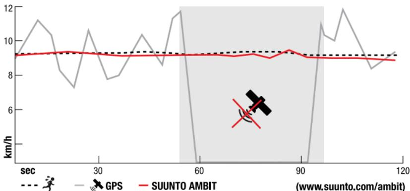
FusedSpeed™ ist besonders nützlich, wenn Sie beim Training hoch responsive Geschwindigkeitsmessungen benötigen, zum Beispiel beim Laufen auf unebenem Terrain oder beim Intervalltraining. Wenn das GPS-Signal zeitweise abbricht, weil beispielsweise Gebäude das Signal blockieren, kann die Suunto Ambit mithilfe des GPS-kalibrierten Beschleunigungsmessers weiterhin genaue Geschwindigkeitsmessungen liefern.
