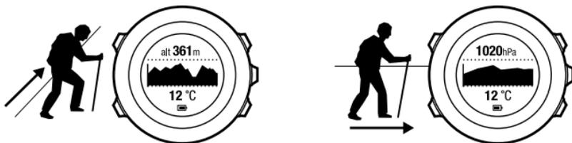
Es ist nicht möglich, Wetter- und Höhenänderungen gleichzeitig zu messen, da beides mit einer Änderung des Luftdrucks einhergeht. Die Suunto Ambit registriert vertikale Bewegungen und wechselt bei Bedarf zur Höhenmessung. Die Höhenanzeige reagiert mit einer maximalen Verspätung von 10 Sekunden auf Höhenwechsel.
